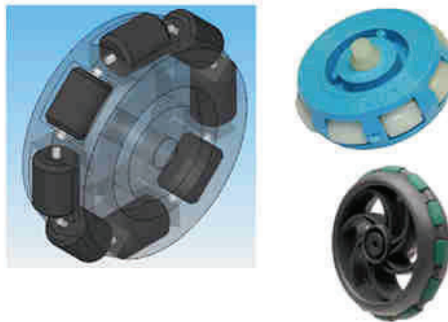
Figura 1.2 Rueda omnidireccional universal, [1]
