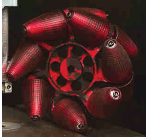
Figura 1.4 Rueda omnidireccional Mecanum, [4]
