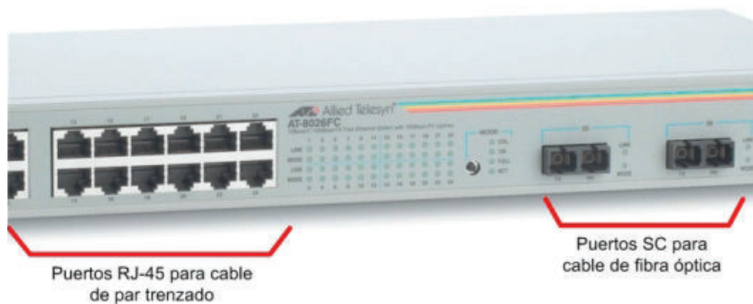
Figura 2. Dispositivos de conexión de red (UTP,FO)
