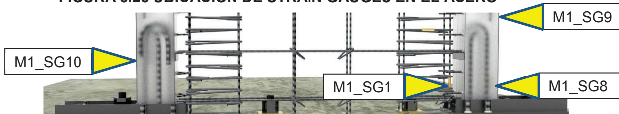
FIGURA 5.25 UBICACIÓN DE STRAIN GAUGES EN EL ACERO
