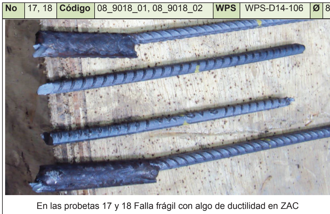
FIGURA 3. 15 FALLA DE LA PROBETA SOLDADA NO. 17 Y 18
