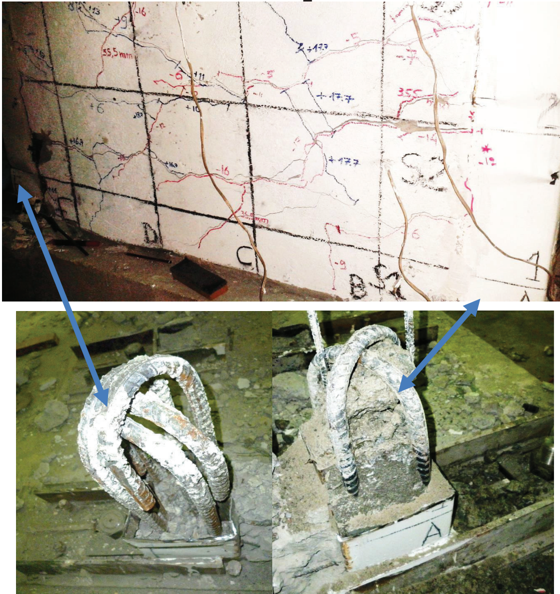
FIGURA 5. 7 AGOTAMIENTO DEL MURO 1_ANCLAJES
