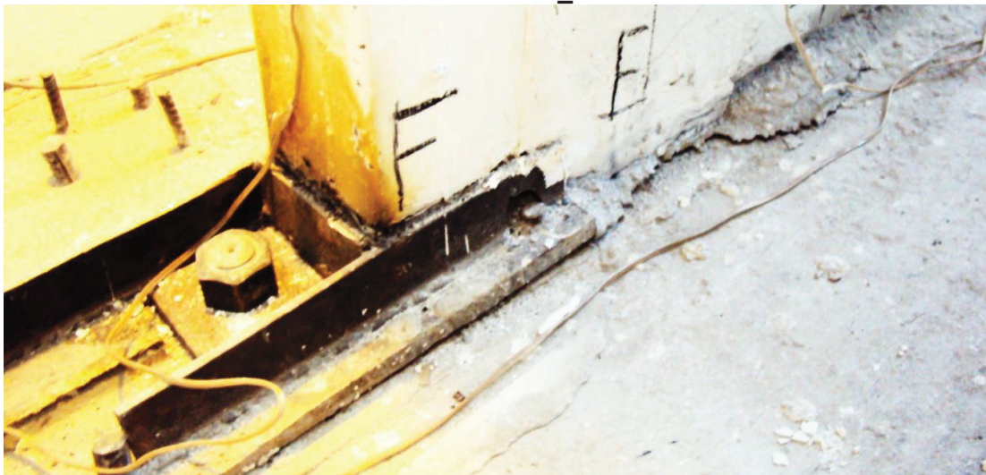
FIGURA 5. 10 AGOTAMIENTO DEL MURO 2_ CABEZAL B
