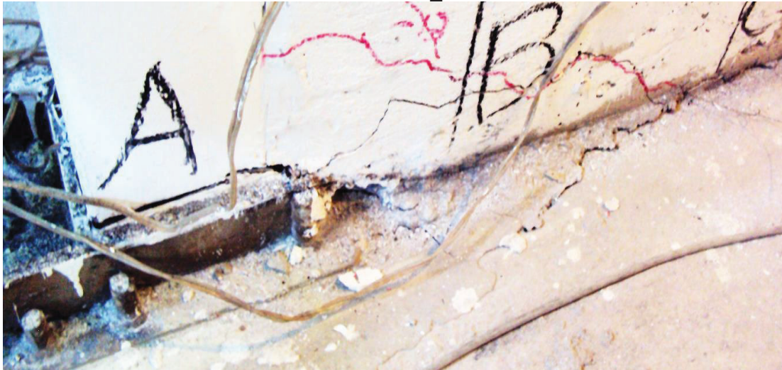
FIGURA 5. 9 AGOTAMIENTO DEL MURO 2_ CABEZAL A
