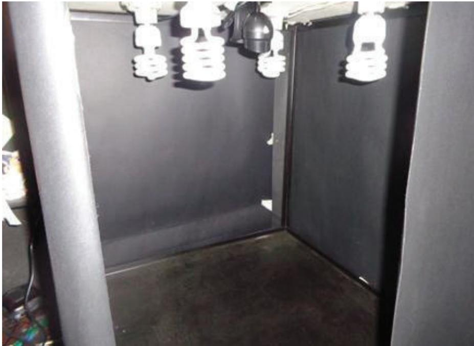
**Figura 4.1 Aislamiento de rayo de luz en la estructura**
