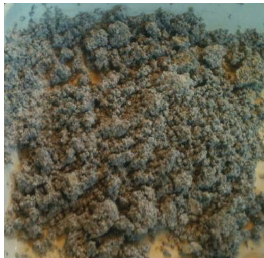
Figura 3.8. Elaboración del panel yeso-piedra pómez con granulometría de 710 \mu\text{m}
