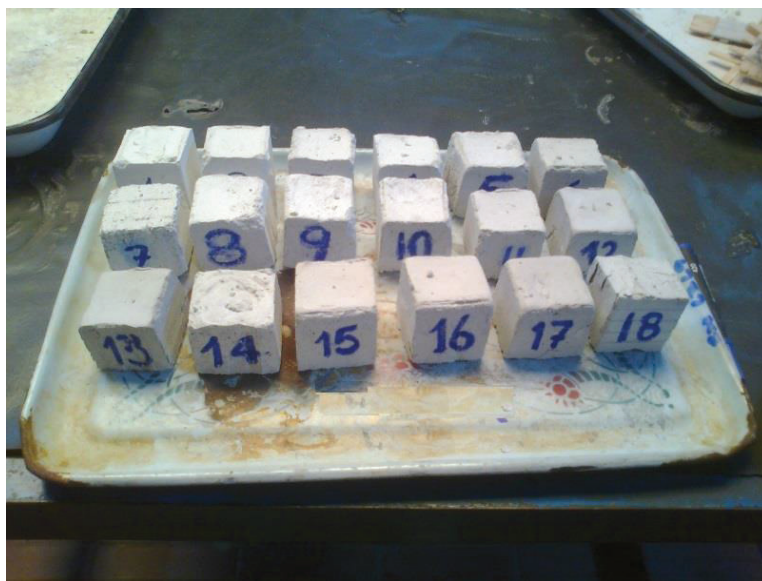
Figura 3.10. Probetas para ensayos de resistencia a la compresión
