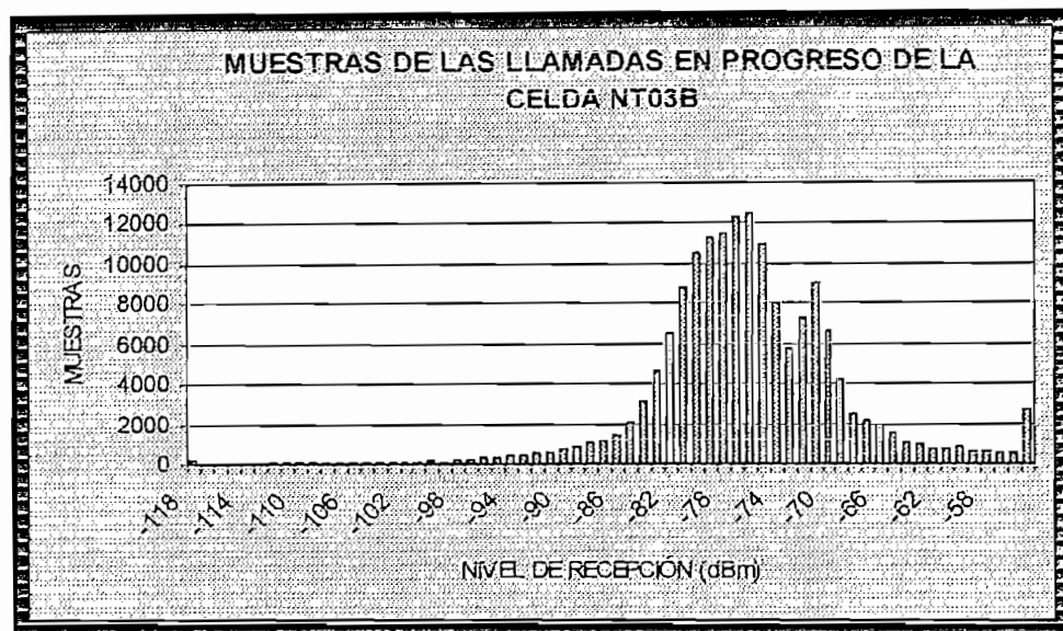
Figura 4.16.- Mediciones de los niveles de recepción de las llamadas en progreso de la celda NT03B
