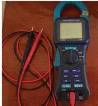
Figura 4.9 Analizador de Carga
