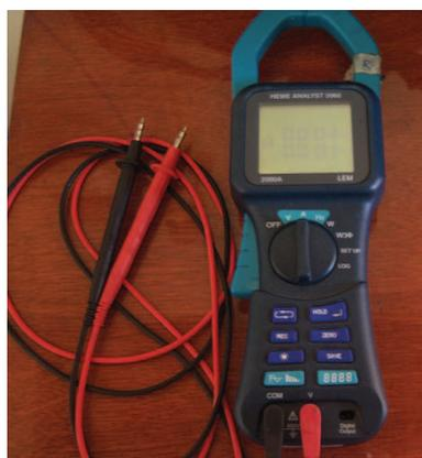
Figura 4.1 Analizador de Carga
