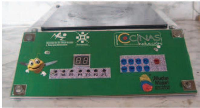
Figura 4.2 Prototipo de la cocina de inducción
