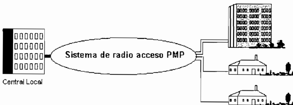
Figura 1.7 Reemplazo del cable de alimentación y distribución con la alternativa PMP.
