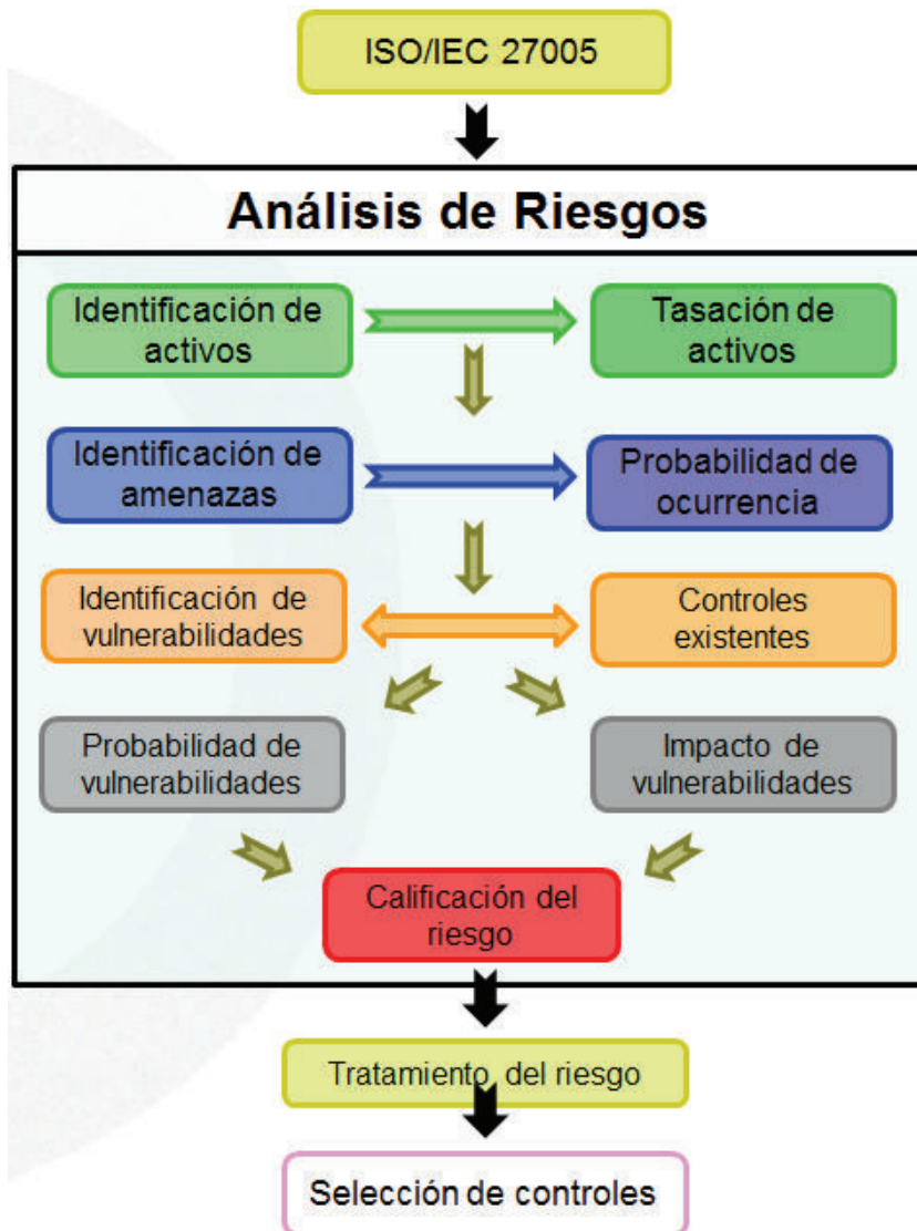
Figura 7. Proceso para determinación del riesgo y su gestión según ISO 27005.
