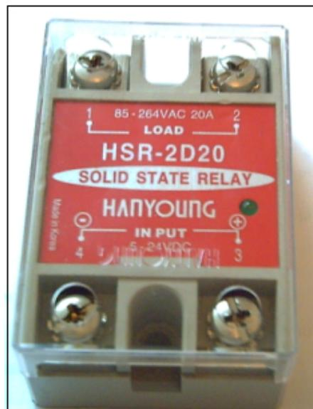
Figura 3.22 Relé de estado sólido para la activación de la electroválvula
