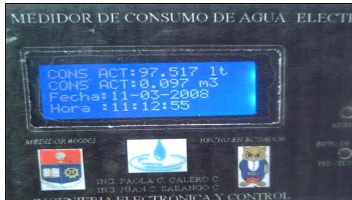
Figura 5.3. Medidor electrónico de consumo de agua
