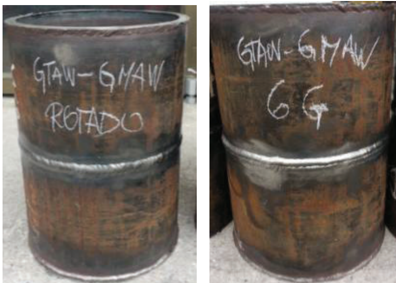
Fotografía 6. 21 Cupones de tubería soldados con proceso GTAW / GMAW, tanto en la posición plana rotada (1GR) y la posición Fija a 45° (6G)
