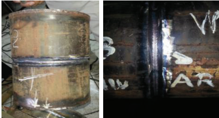
Fotografía 6. 6 Se observa el pase en caliente con proceso GTAW en posición 6G. Presenta una buena uniformidad del cordón de soldadura y libre de defectos.
