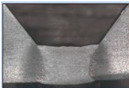
Figura 1. 33 Perfil del pace de raíz realizado con transferencia RMD.
