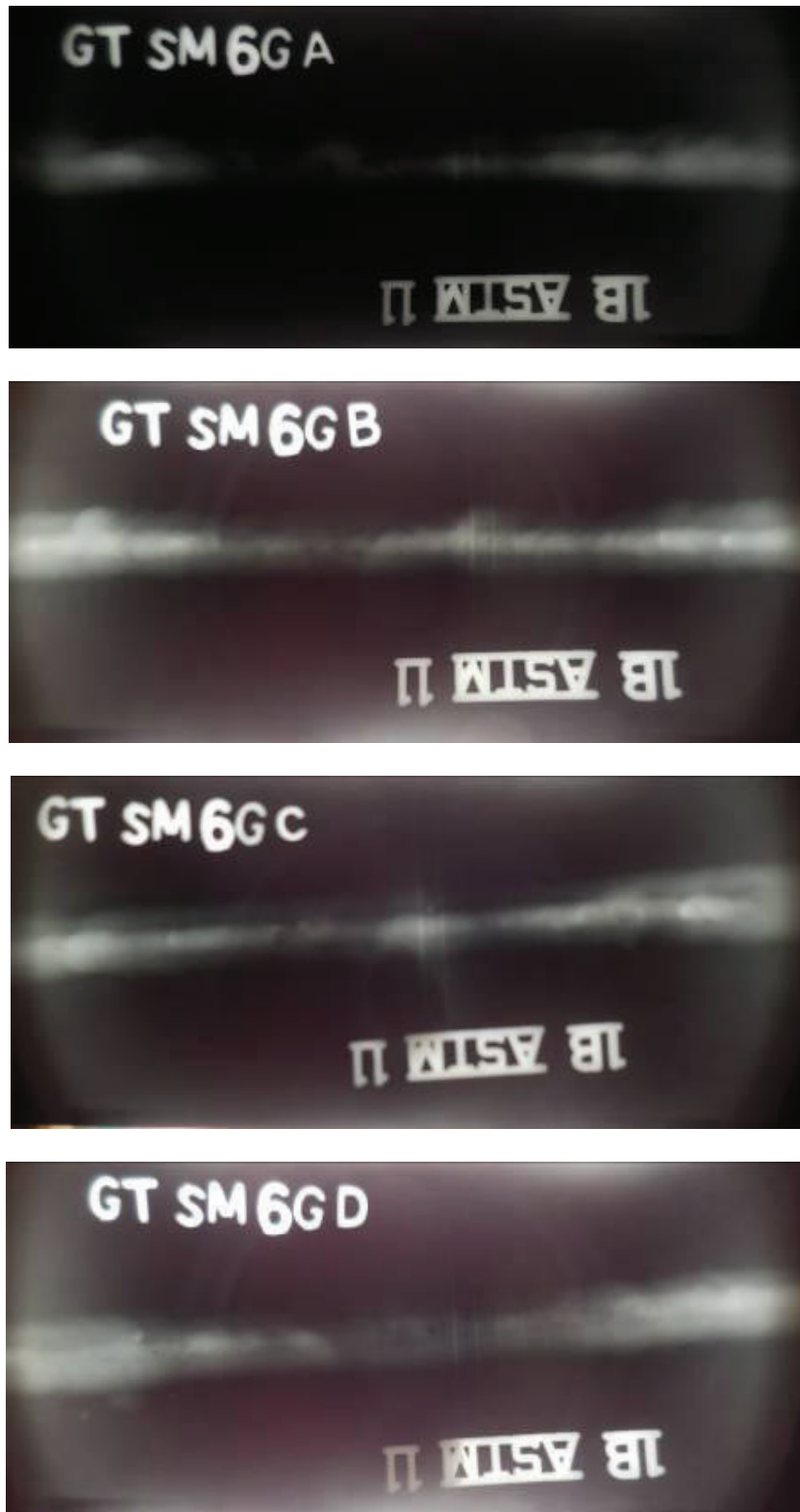
Fotografía B.6 Imágenes de placas radiográficas tomadas por secciones de la junta de soldadura realizada con el proceso GTAW-DMAW en posición 6G en tubería de 8"
