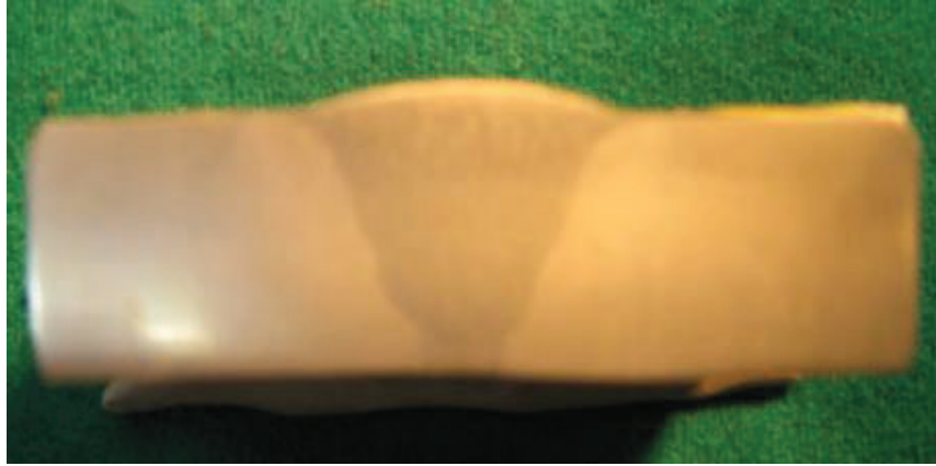
Fotografía 6. 34 Probeta realizada el ensayo macrográfico en el último pase ó pase de presentación realizada con proceso GTAW- GMAW (P), en la posición plana rotada (1GR).
