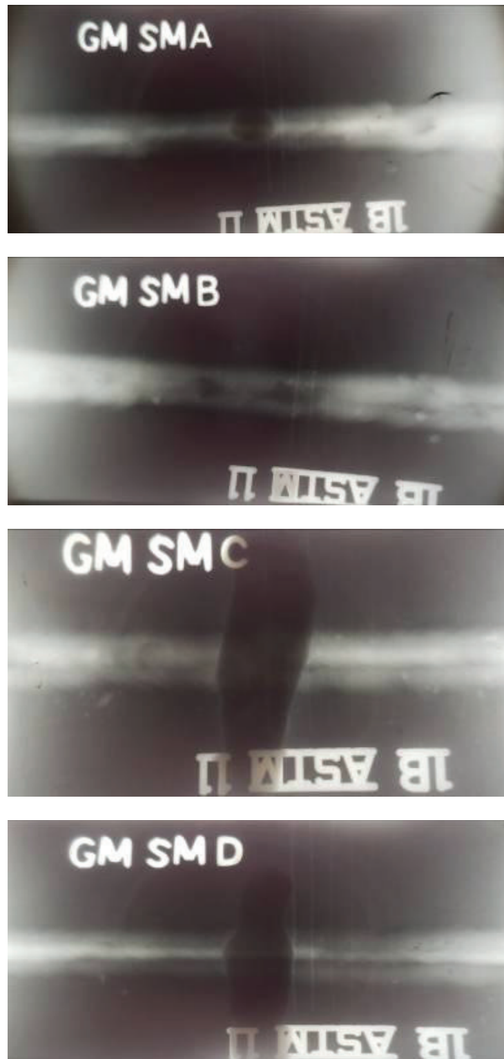
Fotografía B.3 Imágenes de placas radiográficas tomadas por secciones de la junta de soldadura realizada con el proceso GMAW-SMAW en posición 6G en tubería de 8"
