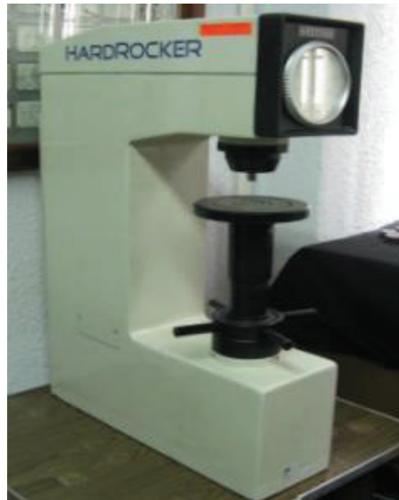
Fotografía 6. 38 Durómetro marca HARDROCKER, medición de dureza escala Rockwell B y C.
