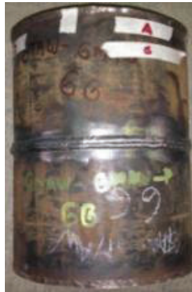
Fotografía 6. 10 Tubería soldada con proceso GTAW / GMAW-P en la posición fija a 45° (6G) PULSADA
