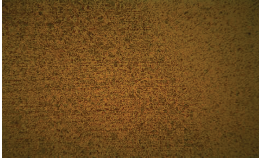
Fotografía 7. 18 Micrografía del material base y la zona afectada por el calor en donde se observa una formación de colonias de perlita y ferrita. Proceso GTAW/GMAW-PULSADO (6G), 100X.
