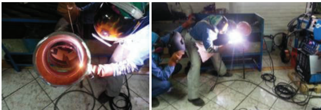
Fotografía 6.4 Soldadura de a) pase de raíz y b) pase en caliente bajo proceso GTAW en posición 6G.
