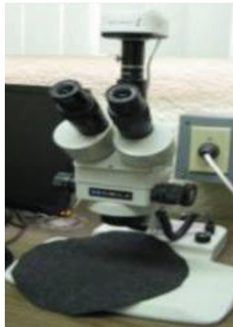
Fotografía 6. 35 Microscopio Estereoscópico, marca MEJI, aumentos de 10X a 70X.
