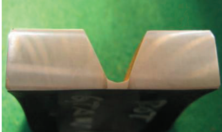
Fotografía 7. 12 Macrografía del cordón de soldadura completado el primer pase (raíz) de soldadura realizado con proceso GTAW (6G), presenta buena penetración y fusión, 10X.
