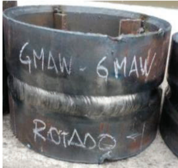
Fotografía 6. 28 Probeta soldada bajo proceso GMAW-GMAW en posición 1G rotado (D. I)
