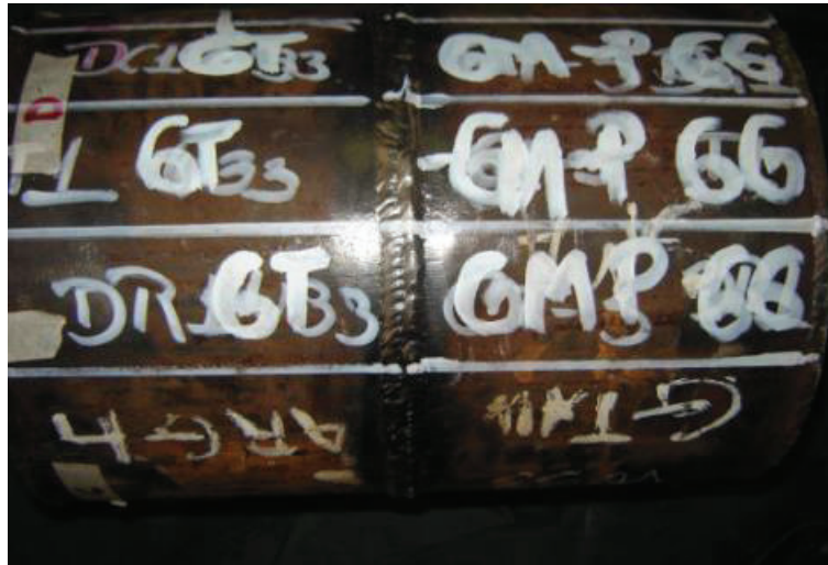
Fotografía 6. 22 Identificación de las probetas del cupón de tubería soldado con proceso GTAW / GMAW, en la posición fija a 45° (6G).
