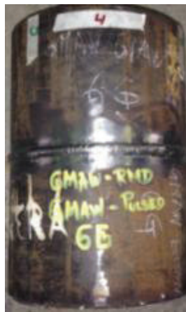
Fotografía 6. 11 Tubería soldada con proceso GMAW - RMD / GMAW - P en la posición fija a 45° (6G) PULSADA
