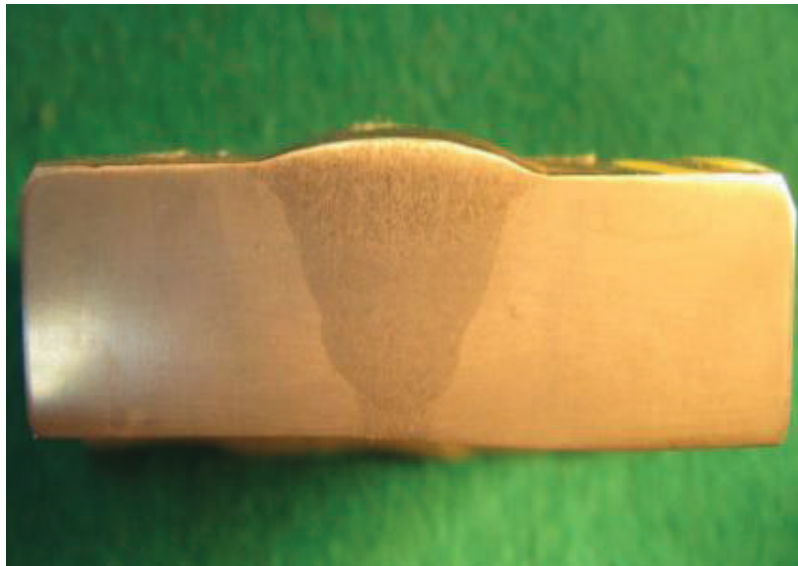
Fotografía 7. 15 Macrografía del cordón de soldadura completado el pase de presentación, realizado con proceso GTAW/GMAW-PULSADO (6G), presenta buena penetración y fusión, 10X.
