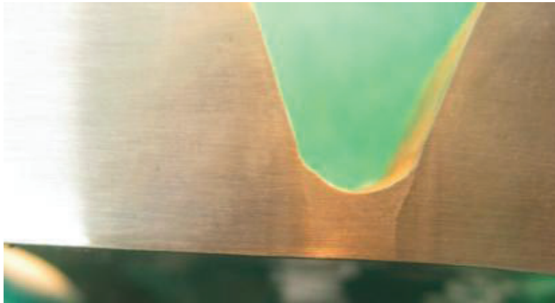
Fotografía 7. 13 Macrografía del cordón de soldadura completado el segundo pase de soldadura (caliente), realizado con proceso GTAW (6G), presenta buena penetración y fusión, 10X.
