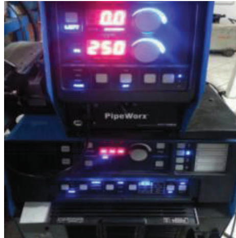
Fotografía 6.3 Preparación del equipo para proceso GMAW-P.
