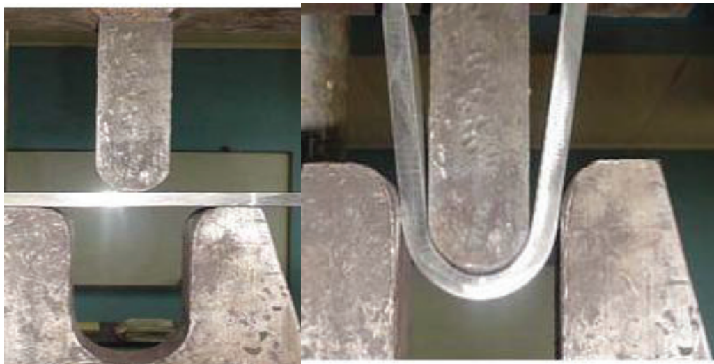
Fotografía 7.7 a) JIG para ensayo de doblado y b) Realización del ensayo de doblado.
