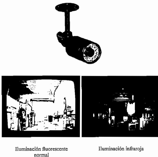
Figura 4.4. Cámara B/N para visión nocturna (Infrarroja).
