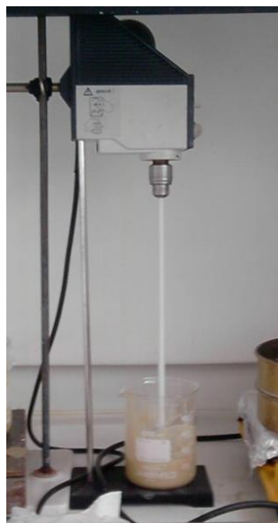
Figura 2.3. Homogenización de las materias primas para la preparación de la suspensión porcelánica S/L: 53/47
