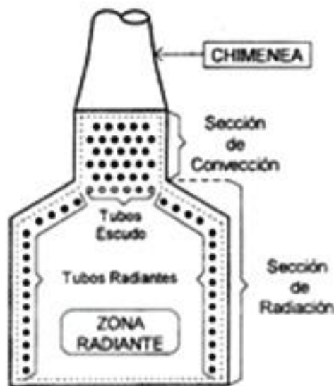
Figura 1.22. Zonas principales de un horno (Wimpress, 2008, p. 2)
