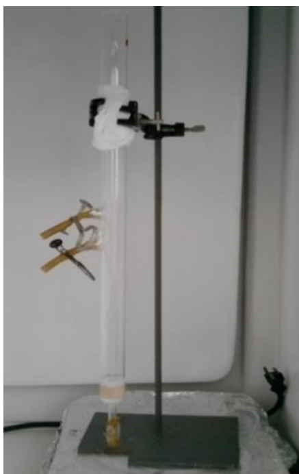
Figura 2.4. Columna de sedimentación de vidrio para las pruebas de estabilidad de la suspensión porcelánica S/L: 53/47
