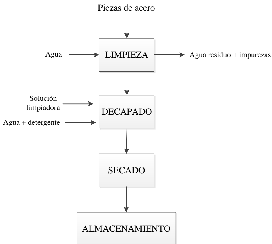
Figura AVI. 4. Preparación de piezas de acero
