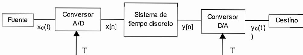
Figura 1.1.14 Sistema de procesamiento digital de señales continuas en el tiempo
