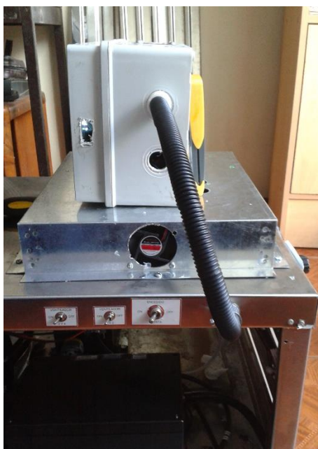
Figura 2.38. Conexión desde la Caja de Control hasta la Caja de relés a través de manguera
