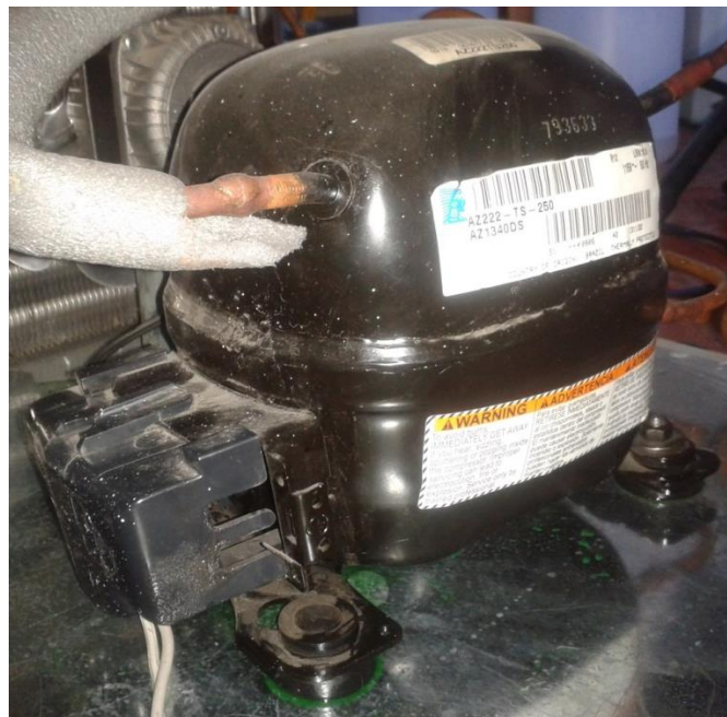
Figura 2.6. Compresor Instalado en la Planta
