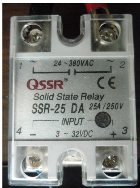
Figura 2.28. Relé de control instalado en la planta
