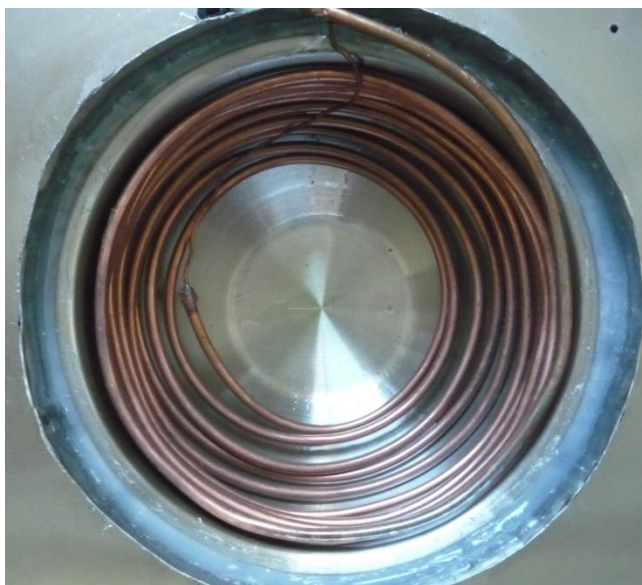
Figura 2.12. Serpentin del Evaporador instalado en el Envase
