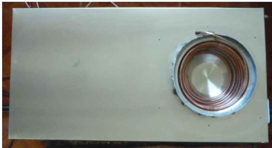
Figura 2.11. Evaporador Instalado en la Planta
