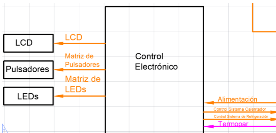
Figura 2.33. Bloque de Control
