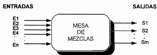
Figura 1.5 Diagrama de una mesa de mezclas con entradas y salidas
