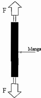
al final del cable ( figura 1.13), la fuerza se aumenta en 225 Newtons incrementados en cinco minutos hasta que se produzca un daño. La ruptura de la faja de unión estará entre 450 y 600 Newtons, pero esto no producirá daños en el sistema de cierre de la manga.
