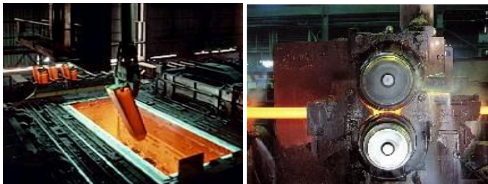
Figura 7: El Proceso de Laminación
