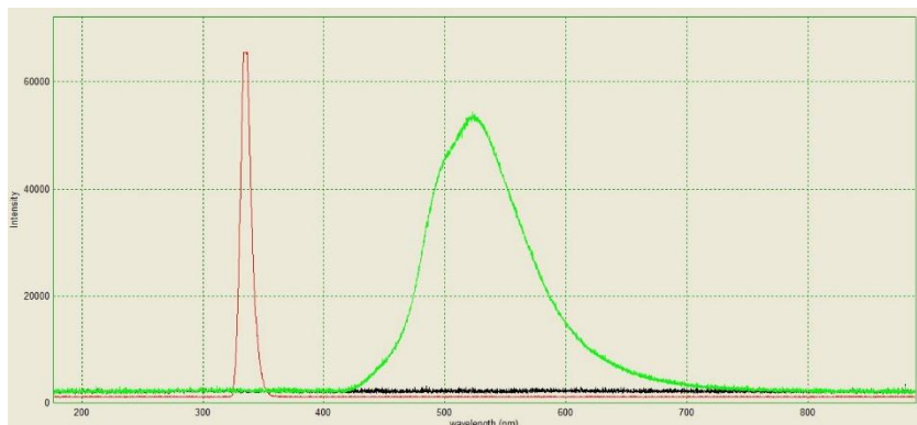
Figura 0.17. Espectro de agua residual (concentración baja) con espectrómetro luego de ser enfocada con la fuente luminosa UV.
