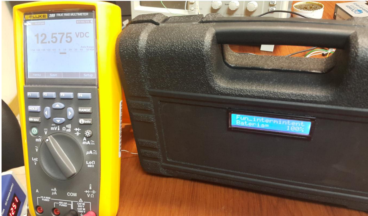
Figura 0.8. Prueba de censado de batería y visualización en el LCD del porcentaje de carga.
