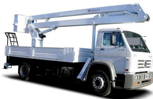
Figura 1.13 Plataforma para mantenimientos
