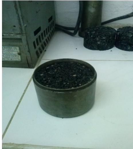
Fotografía 3.16 Probeta asfáltica compactada
