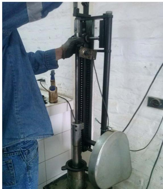
Fotografía 3.15 Compactación de Probetas asfálticas
