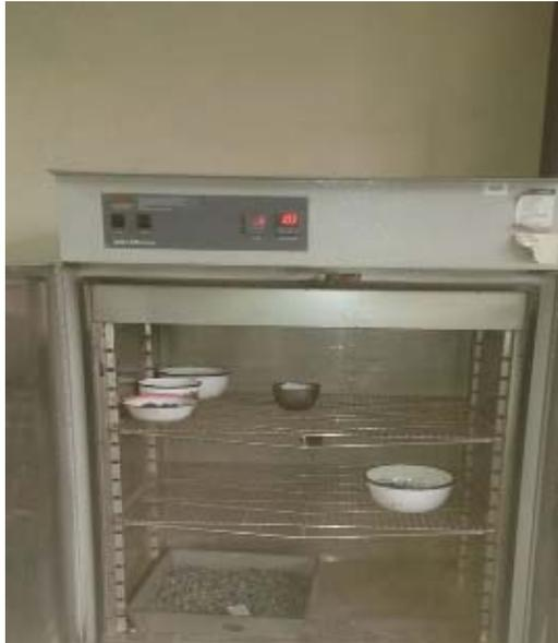
Fotografía 3.9 Secado de los agregados a una temperatura constante de 105° a 110° C
