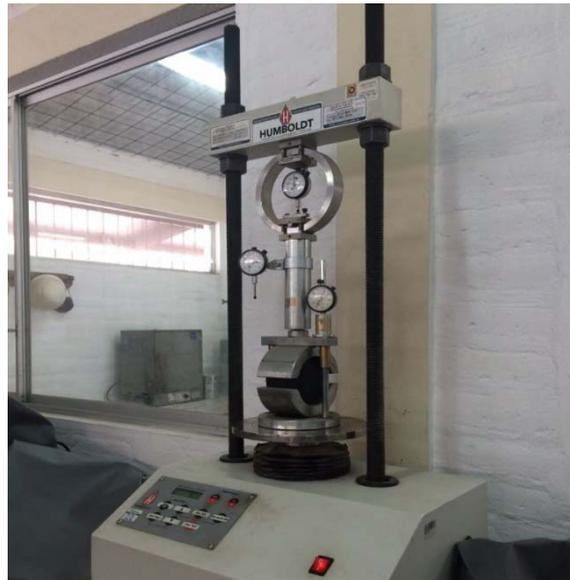
Fotografía 3.21 Prensa para rotura de probetas mediante el Método Marshall
