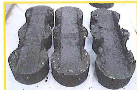
Probetas después de la prueba de pista, de izquierda a derecha 0.3% de K-12, 0.5% de K-14 y AC-20
