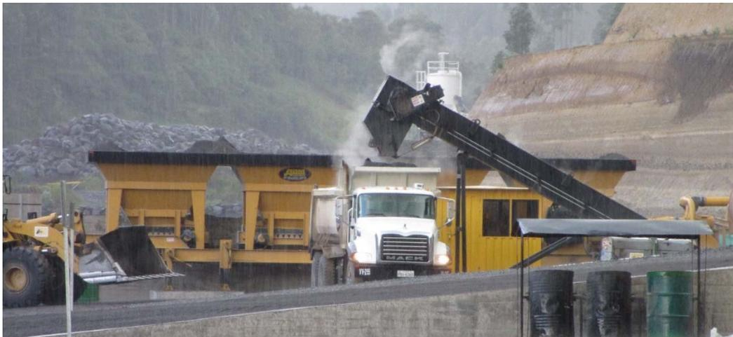
Fotografía 4.3 Descarga de la mezcla asfáltica en caliente en una volqueta
