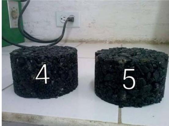
Fotografía 3.20 Briquetas antes del ensayo “RP”
