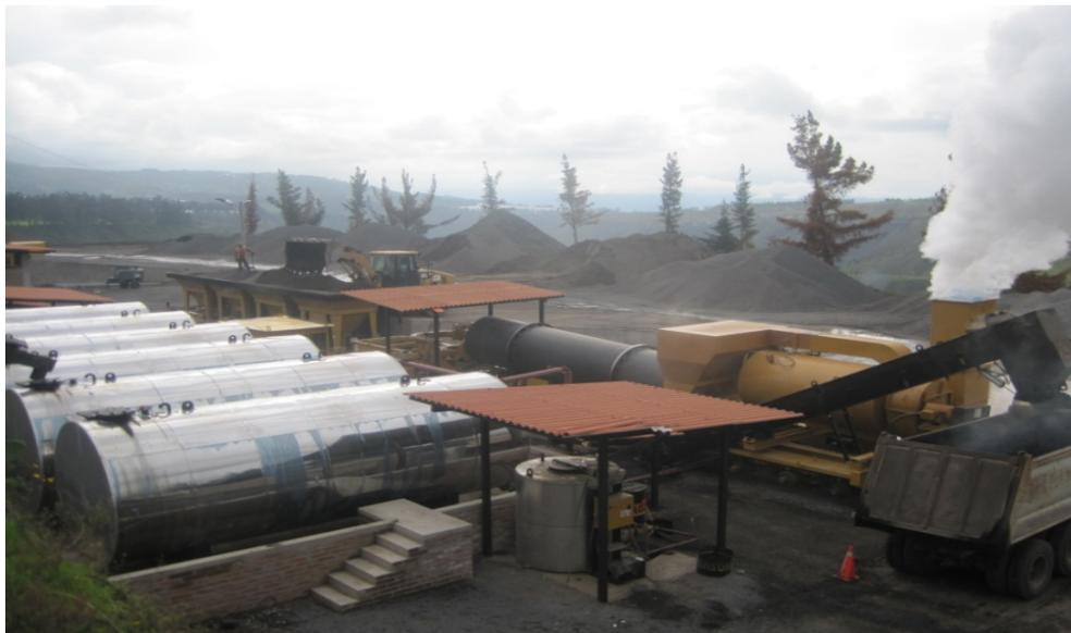
Fotografía 1.3 Planta de asfalto para mezclas en caliente<sup>25</sup>
