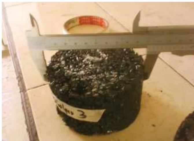
Fotografía 3.17 Probeta asfáltica compactada
