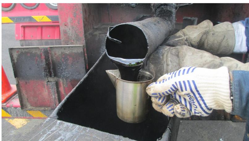
Fotografía 3.2 Muestreo in situ del cemento asfáltico
