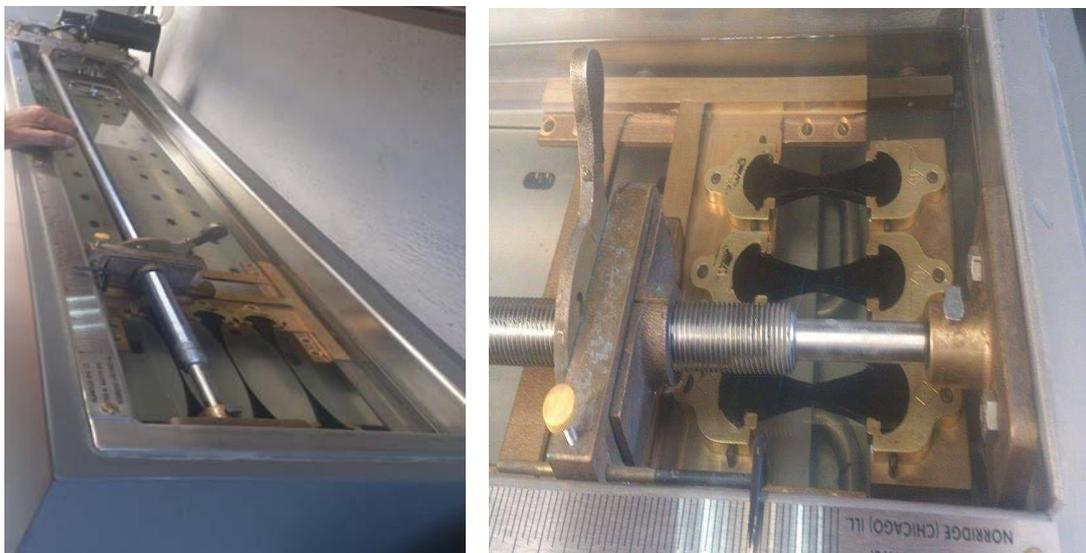
Fotografías 3.5 Equipo para ensayo de ductibilidad
