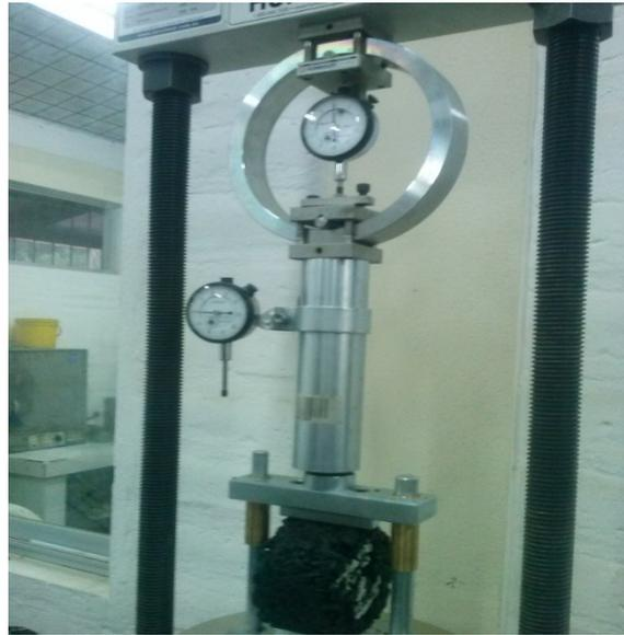
Fotografía 3.23 Prensa Ensayo de Tracción Indirecta (Método Brasileño)
