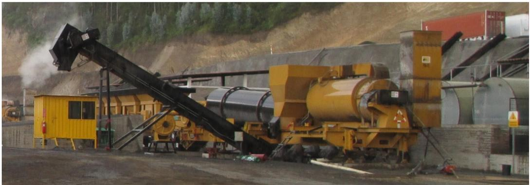
Fotografía 1.1 Planta de asfalto continua de flujo paralelo<sup>23</sup>
