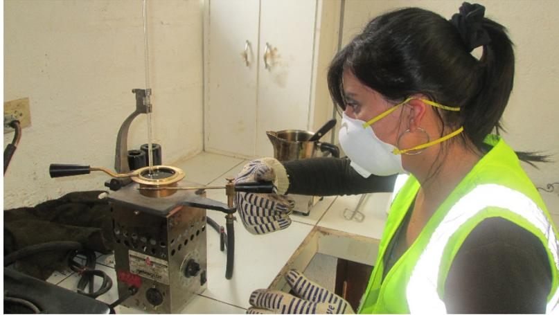
Fotografía 3.6 Equipo para para ensayo de punto de inflamación
