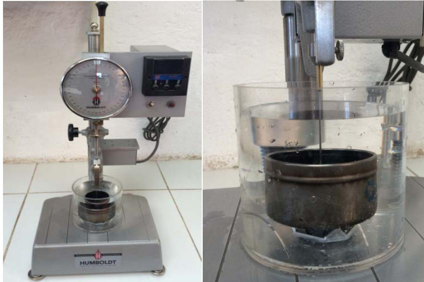
Fotografía 3.4 Equipo para ensayo de penetración
