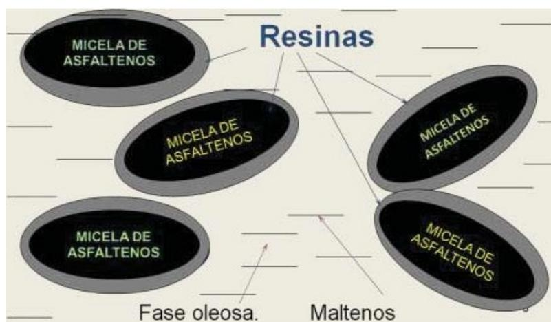
Figura 1.3 Estructura coloidal del asfalto<sup>9</sup>
