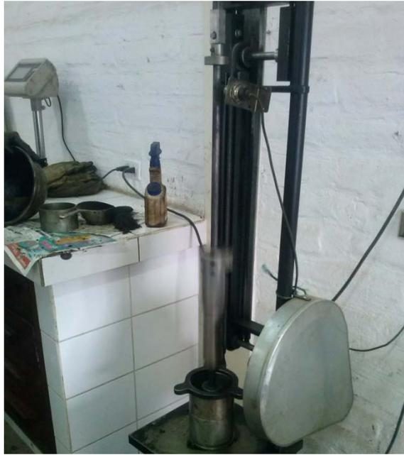
Fotografía 3.14 Martillo Marshall para compactar las briquetas
