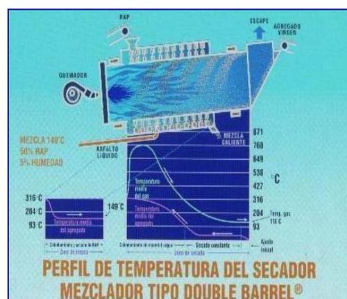
Figura 2.1 Perfil de temperatura de un secador mezclador de una planta de asfalto
