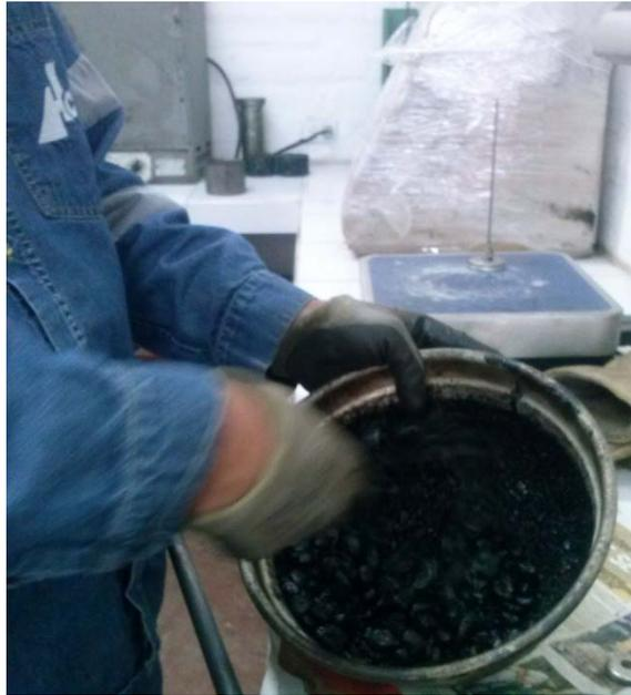
Fotografía 3.11 Proceso de mezclado del pétreo con el asfalto
