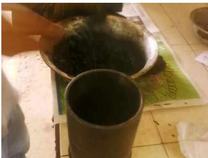
Fotografía 3.13 Colocación de la mezcla en el molde Marshall
