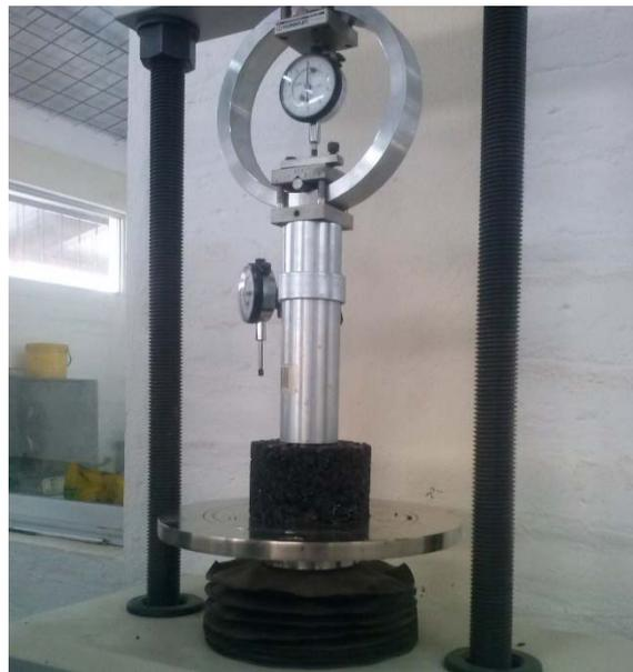
Fotografía 3.22 Prensa para roturas de probetas mediante el método "RP"
