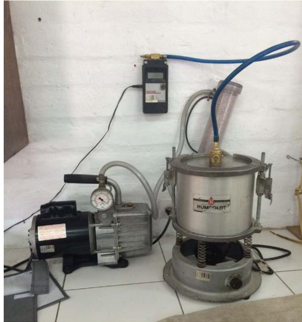
Fotografía 3.19 Picnómetro de metal con tapa transparente
