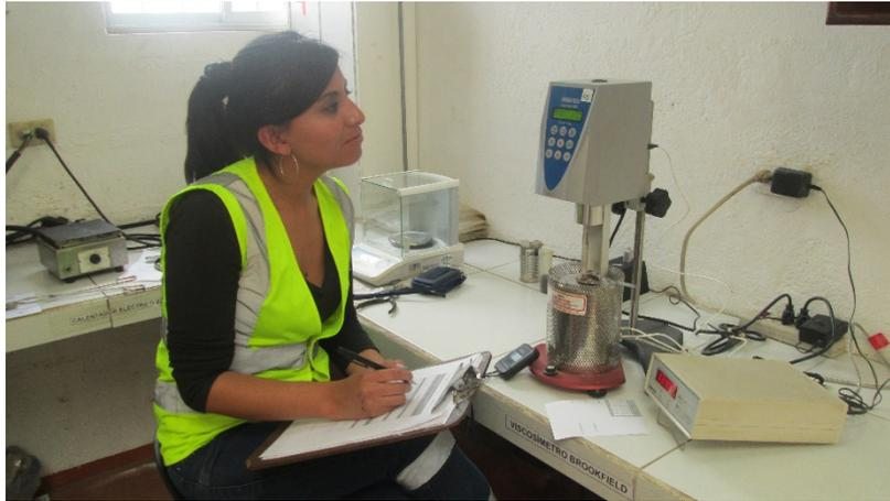
Fotografía 3.7 Equipo para para ensayo de viscosidad
