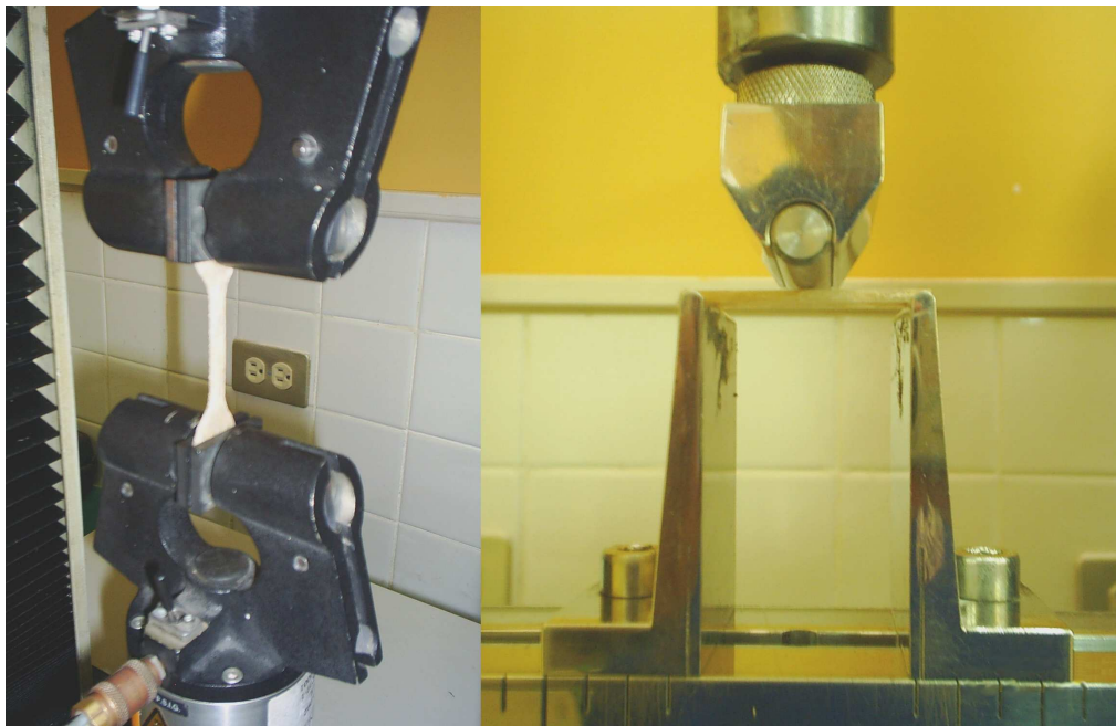
Figura 4.9. Muestras ensayadas a tracción y flexión en la máquina universal de ensayos marca Instron de donde se obtuvo los resultados de este estudio.
