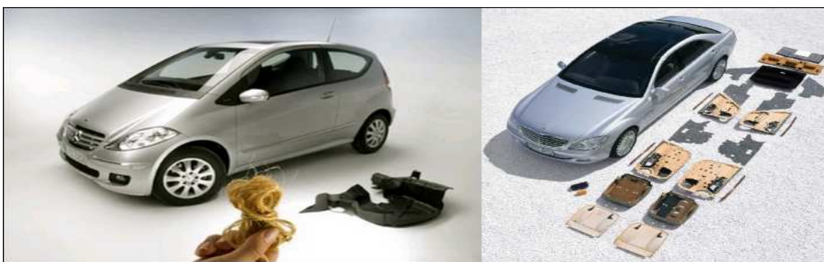
Figura 1.20. Autopartes de abacá en vehículos Mercedes Benz Clase 500 construidos por Daimler Chrysler. [INTERNET 15]
