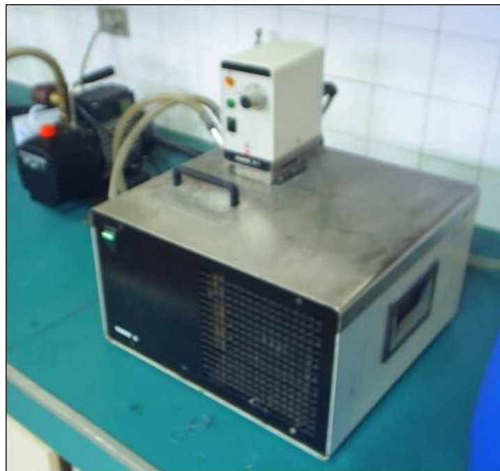
Figura 3.15. Baño térmico que controla el caudal del agua de enfriamiento.
