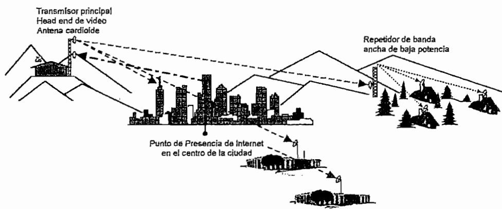
Figura 3.26. Configuración de la transmisión MMDS: transmisor distante con el headend de Internet y el Punto de Presencia en el centro de la ciudad.
