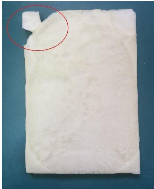
Figura 3.4. Problemas en el material compuesto cuya carga era del 15% de fibra
