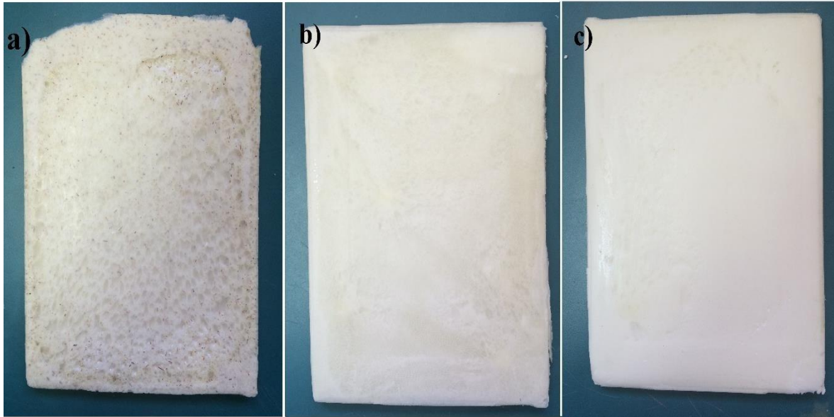
Figura 3.1. Material compuesto formulado con diferentes temperaturas de molde a) 40°C, b) 50°C y c) 60°C
