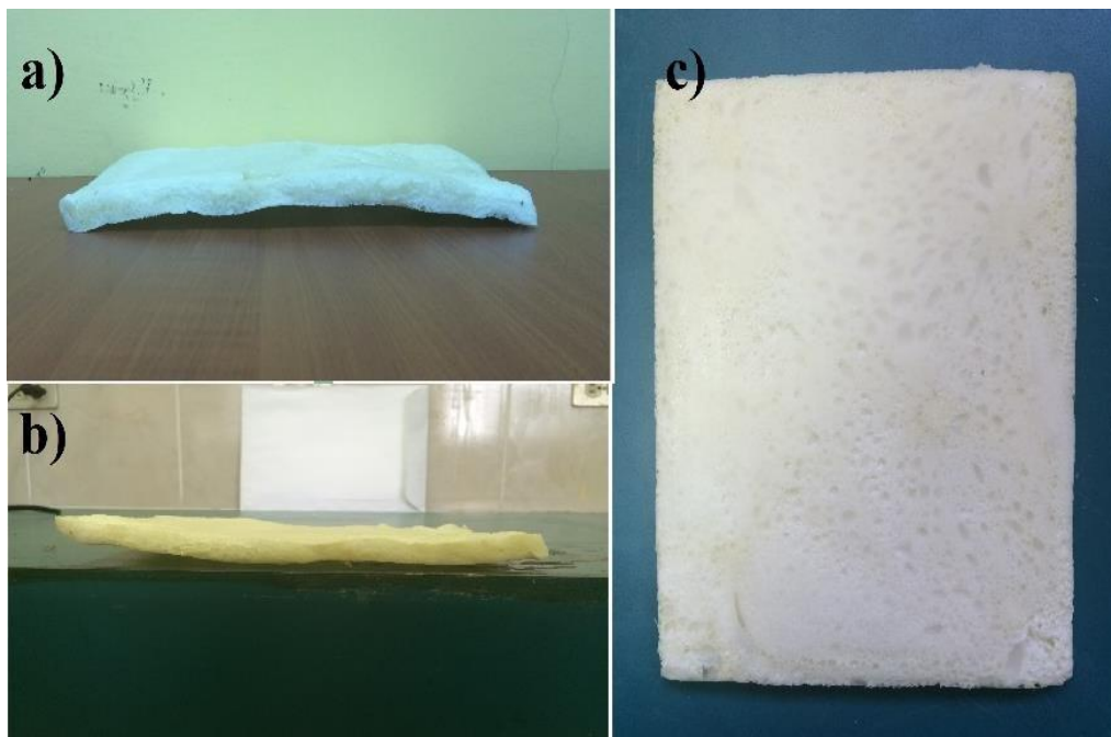
Figura 3.2. Fallas debido a los diferentes tiempos de moldeo a) y b) Falta de estabilidad dimensional, c) Porosidad en el acabado superficial
