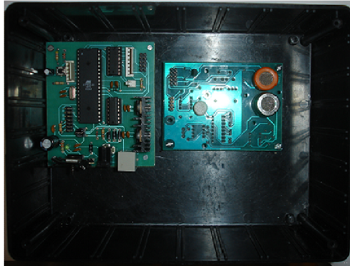
Figura 3.35 Placas montadas en la caja
