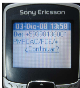
Figura 4.5 Recepción de mensaje de Falla de Energía en la estación central.
