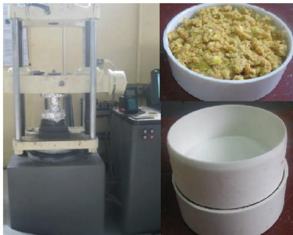
Figura 2-1: Materiales para el ensayo de compresión
