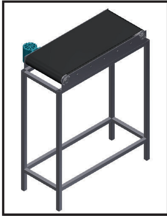
Figura 3.3: Vista de un transportador de bandas.
