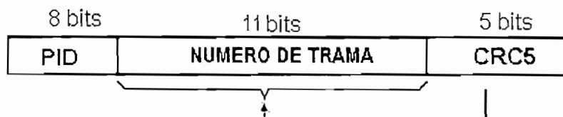
Figura 1.23: Formato de paquete Inicio de Trama
