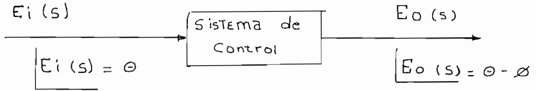
DESFASSAGE DE UN SISTEMA DE CONTROL
