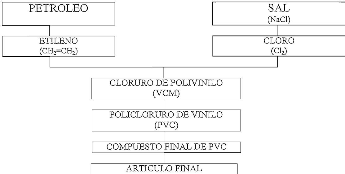
Figura 2.1.- Desde el petróleo y la sal hasta la producción del artículo de PVC.
