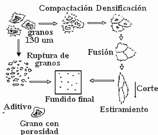
Figura 2.4.- Mecanismo de gelificación durante el procesamiento
