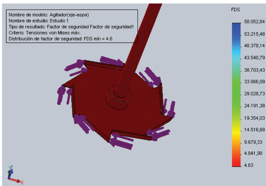
Fig. 4.7 factor de seguridad del conjunto eje-aspas
