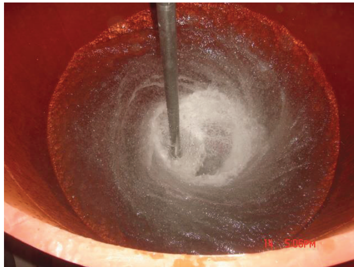
Foto 3. Tanque mezclador de pinturas.
