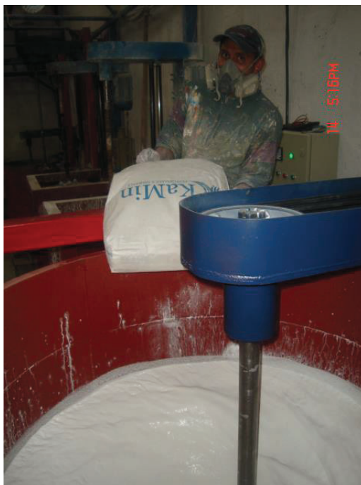
Foto 6. Colocación de cargas a la mezcla
