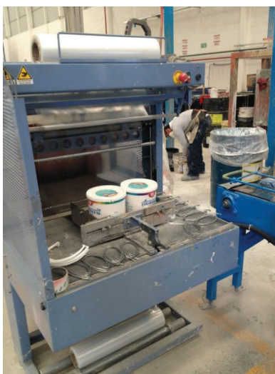
Foto 11. Proceso de termo sellado a la entrada.
