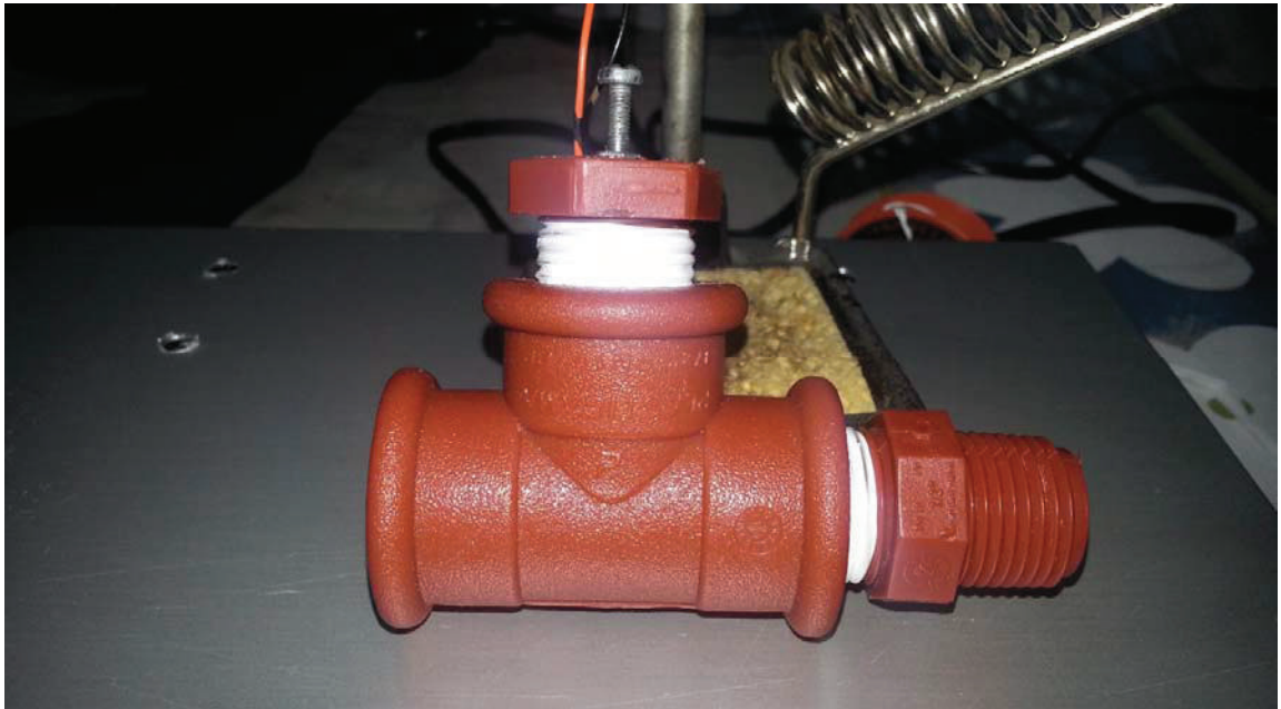
Figura No.3.7: Sensor con el soporte y elemento de entrada del fluido.
