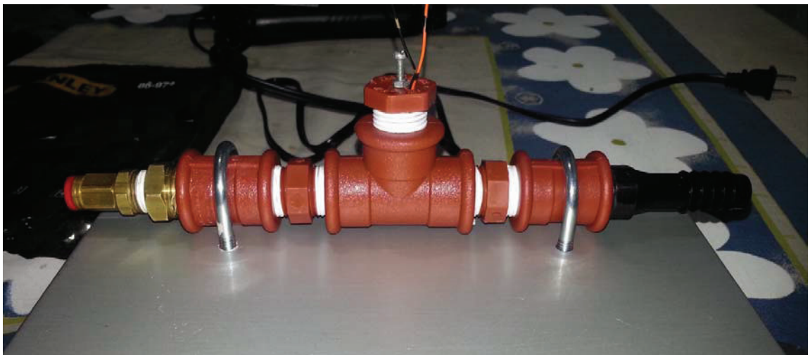
Figura No.3.8: Vista del sensor con todos sus componentes sobre el soporte.
