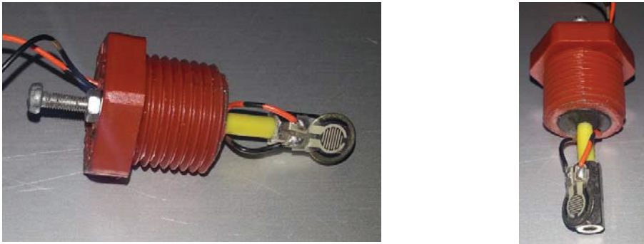
Figura No.3.3: Soporte del sensor, con todos sus elementos.
