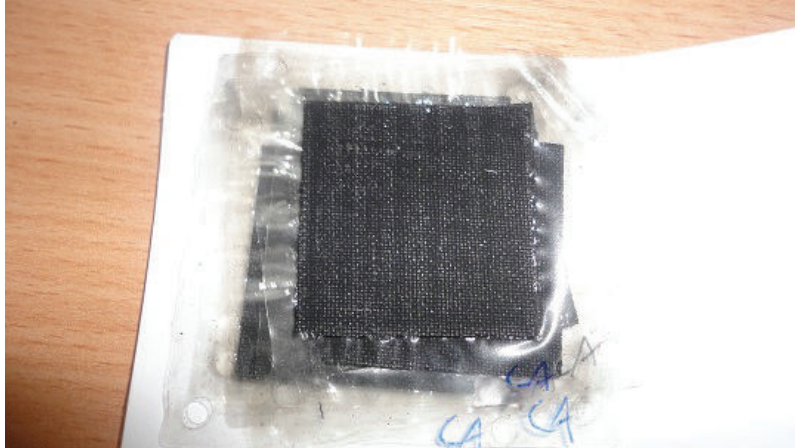
Fig. 3-6 MEA (Ensamblaje Membrana – Electrodo)
