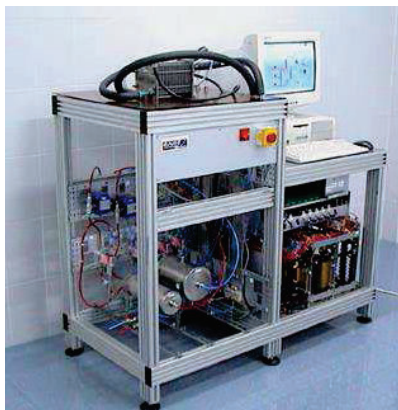
Fig. 2-9. Estación de ensayo de pilas de combustible tipo PEM [44]
