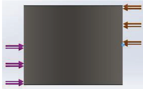
Figura 3.13. Aplicación de cargas sobre la chaveta
