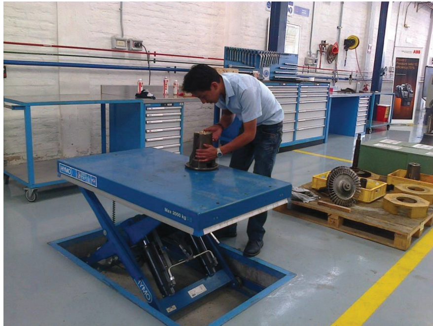
Figura 1. 7: Altura inferior de la mesa con respecto al operador
