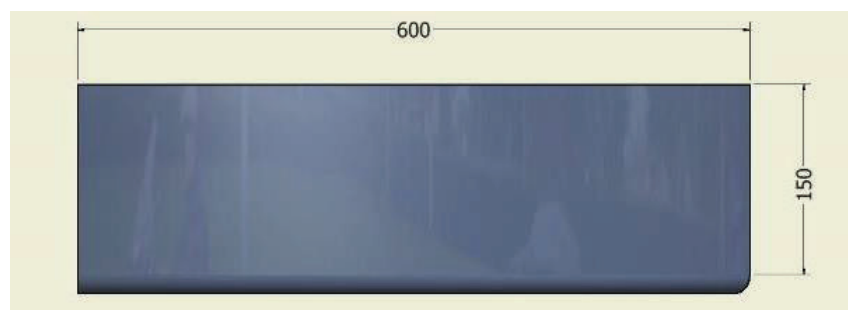
Figura 5. 15 Diagrama con dimensiones de la paleta
