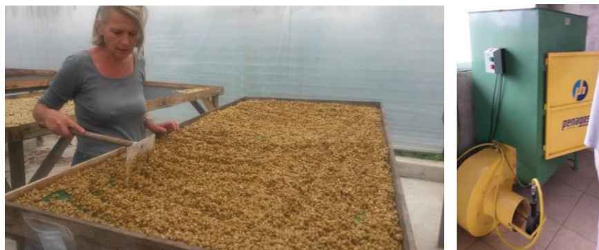
Figura 3. 11 (a) Removiendo el café durante el proceso de presecado en la finca Maputo, Secador de Café, (b) Penagos de bandejas de tres Pisos
