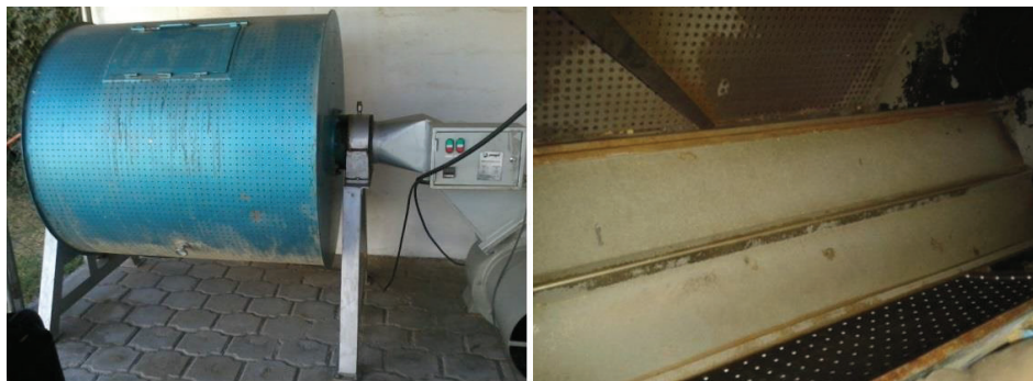
Figura 3. 3 (a) Secador Tipo Guardiola (b) Composición interna del Secador tipo Guardiola con bandejas
