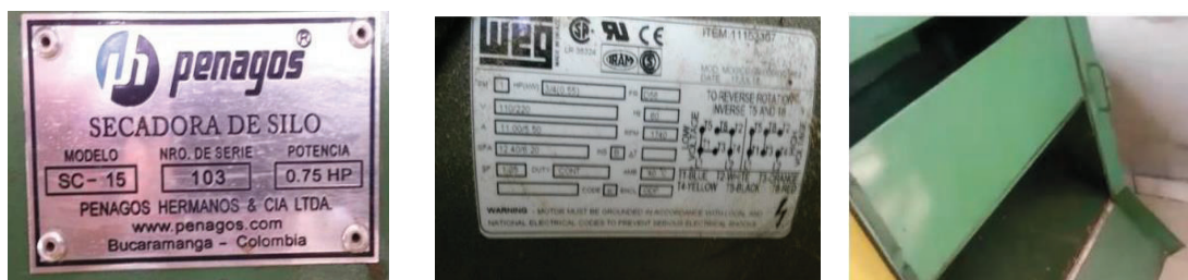
Figura 3. 12 (a) Especificaciones del Secador de Silo de tres pisos, (b)Especificadores del Motor del Ventilador, (c) Bandejas de tres pisos para el Secador de Silo
