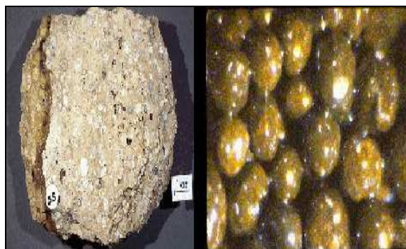
Figura 2.7: Tamaño y redondez del propante Gráfico proporcionado por la CIA Scclumberger
