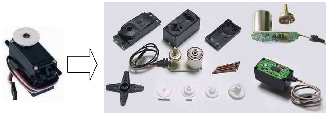
Figura 3.10 Despiece de un servomotor de modelismo [15]
