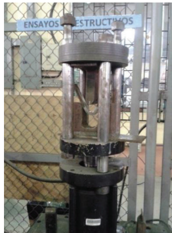
Figura 3.56.- Doblado de la probeta
