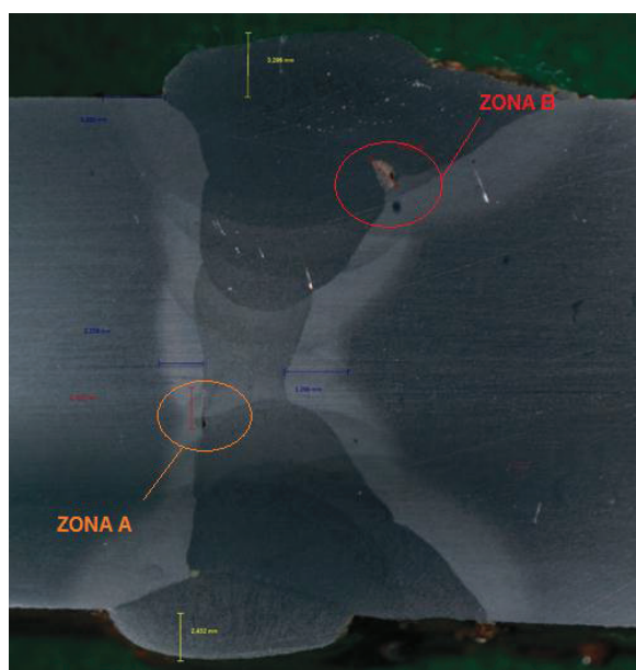
Figura 4.1.- Macrografía de la probeta de calibración PC1 a 4X
