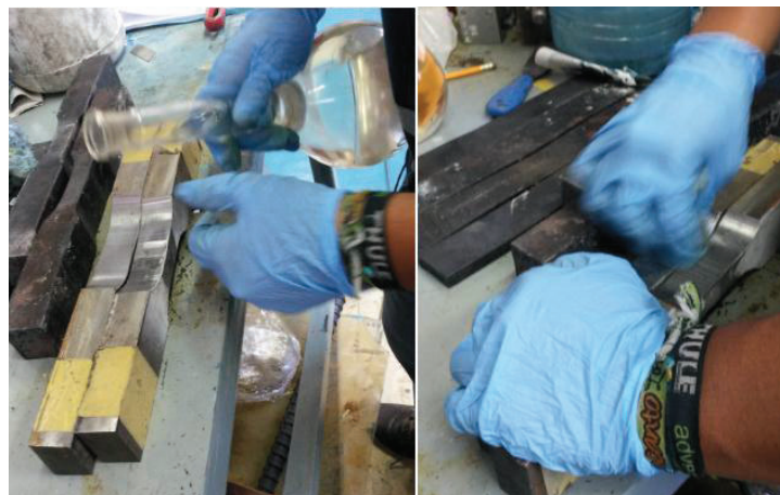
Figura 3.46.- Ataque con nital al 10 % en la zona del cordón de soldadura
