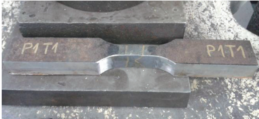
Figura 3.47.- Distinción de la Zona de soldadura
