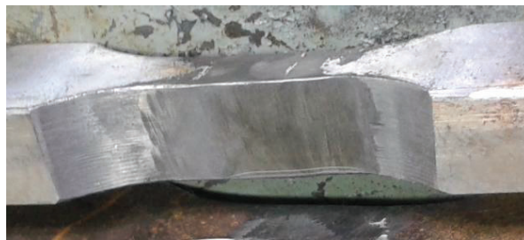
Figura 3.45.- Eliminación de rebabas e impurezas de la superficie de la probeta de tracción
