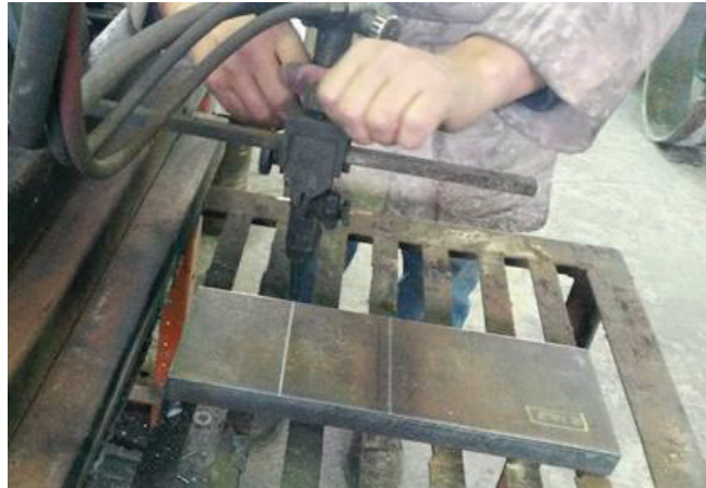
Figura 3.11.- Alineación de la boquilla de oxicorte
