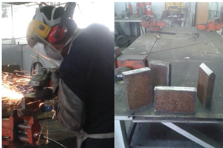
Figura 3.16.- Esmerilado de rebabas de oxígeno
