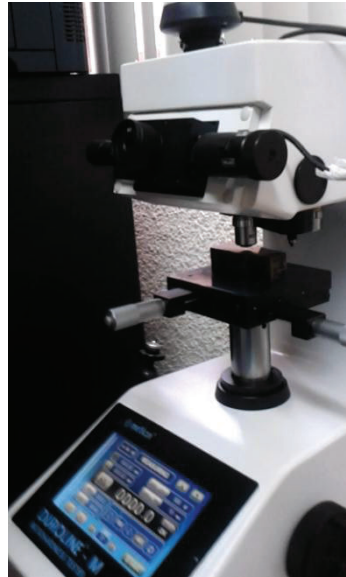
Figura 3.42.- Selección de parámetros para el ensayo de micro dureza
