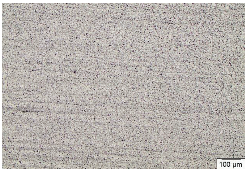
Figura 4.18.- Microestructura a 100X correspondiente a la ZAC con descomposición de la perlita distribuida uniformemente
