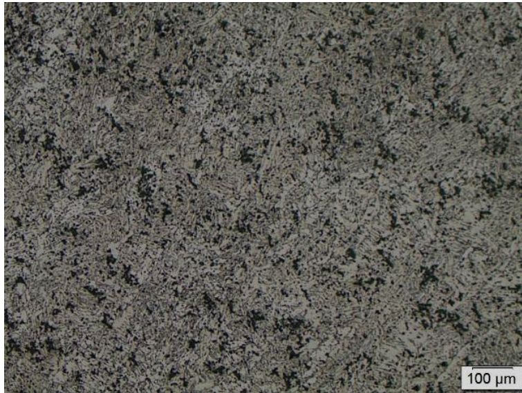
Figura 4.46.- Microestructura a 100X correspondiente al material de aporte atacada con nital al 10%
