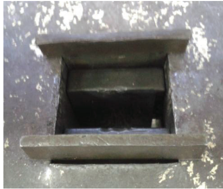
Figura 3.49.- Mordazas de la máquina universal de ensayos
