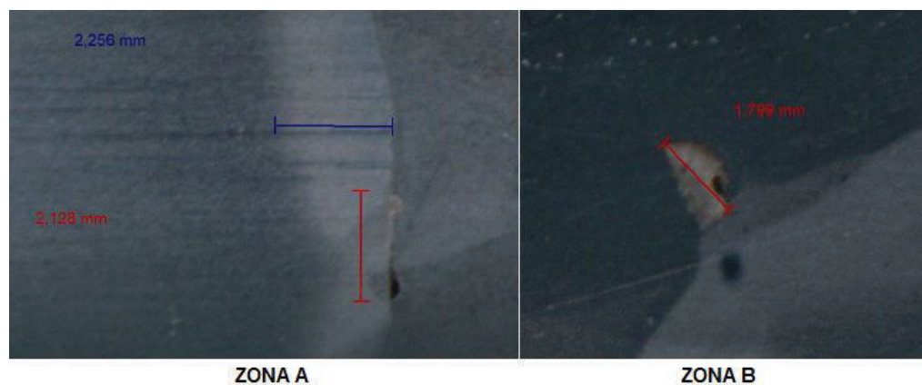
Figura 4.2.- Ampliación de falta de fusión de la probeta PC1
