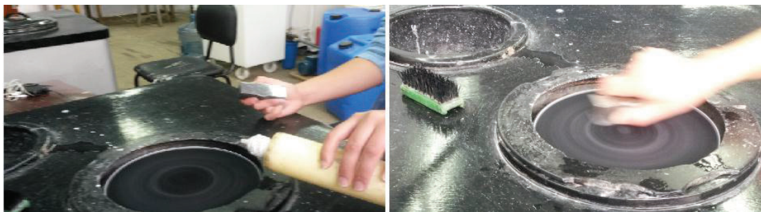
Figura 3.35.- Pulido fino en paño con alúmina de 1 micra
