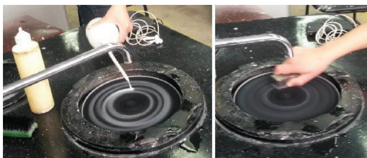
Figura 3.36.- Pulido fino con alúmina de 0,3 micras
