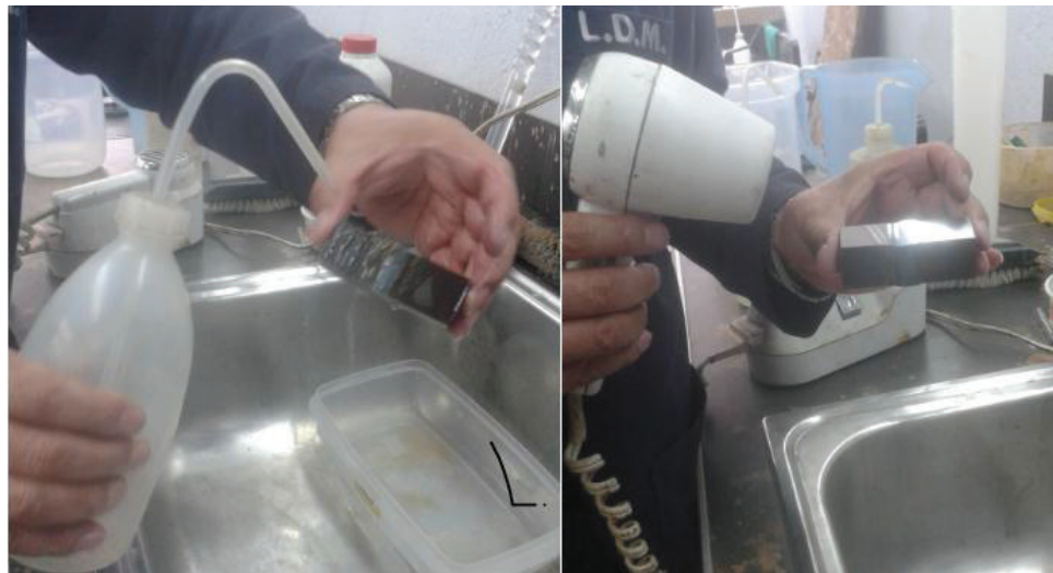
Figura 3.33.- Limpieza de la probeta después del desbaste grueso
