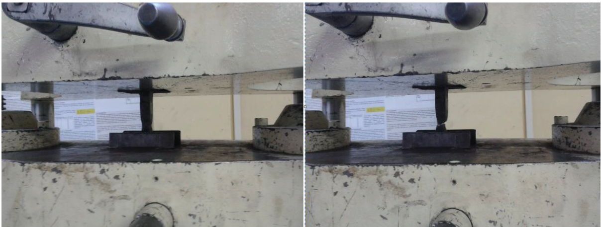
Figura 3.52.- Falla de la probeta de tracción
