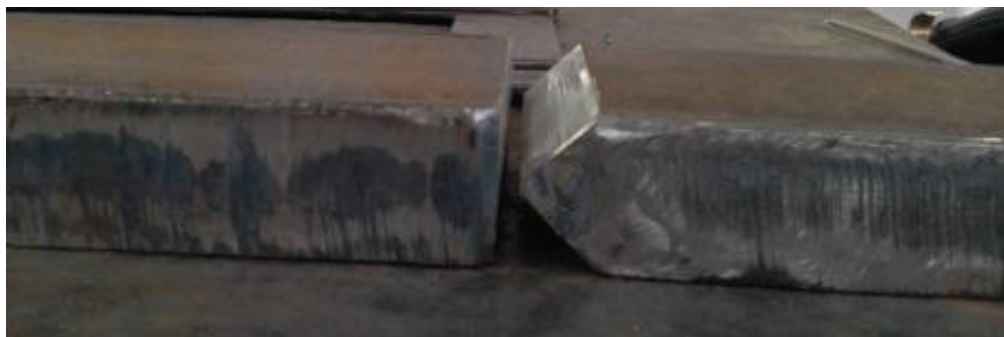
Figura 3.20.- Alineación de la junta tipo K
