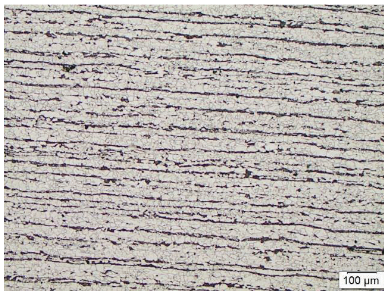
Figura 4.16.- Microestructura a 100X correspondiente a un acero de bajo contenido de carbono con perlita alineada en dirección al laminado en una matriz ferrítica atacado con nital al 10%
