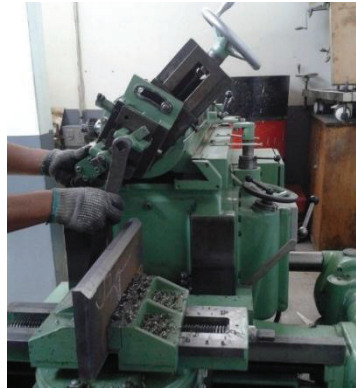
Figura 3.6.- Giro de cabezal y centrado de la cuchilla sobre la placa
