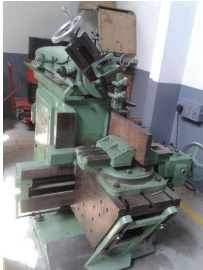
Figura 3.2.- Ubicación cabezal de la limadora a 45°
