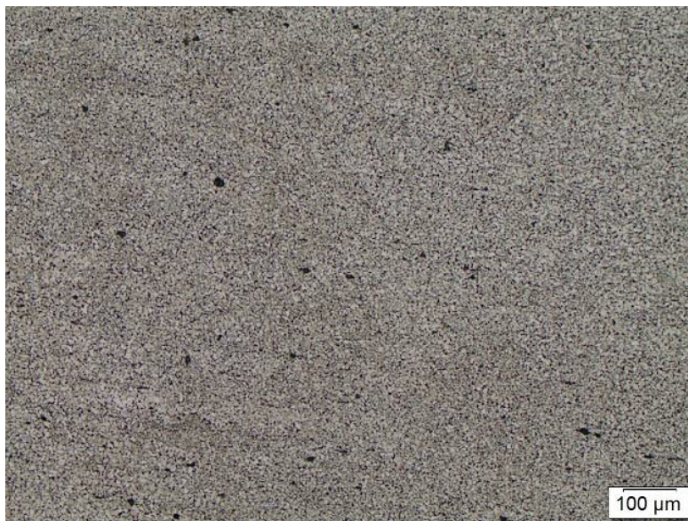
Figura 4.44.- Microestructura a 100X correspondiente a la ZAC atacada con nital al 10%
