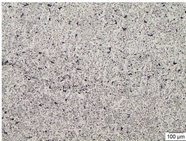
Figura 4.20.- Microestructura a 100X correspondiente al material de aporte con descomposición de la perlita con presencia de ferrita acicular
