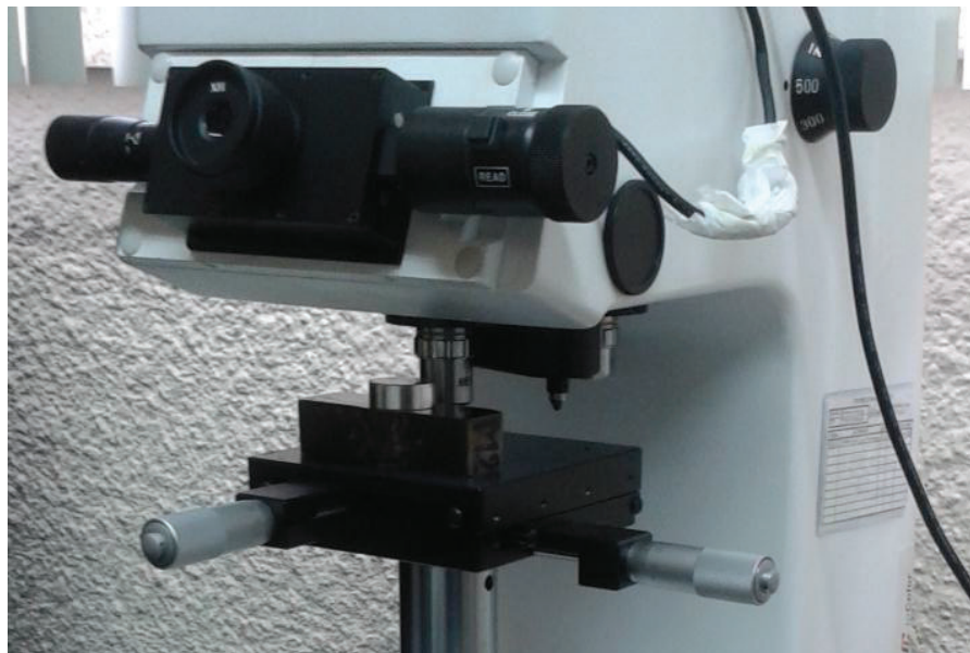
Figura 3.41.- Nivelación de la probeta en el micro durómetro
