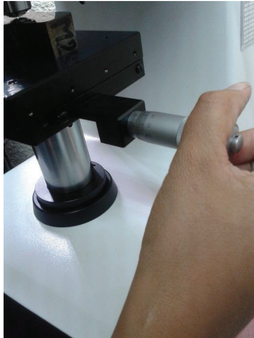
Figura 3.44.- Indentación de la probeta cada 2 [mm]
