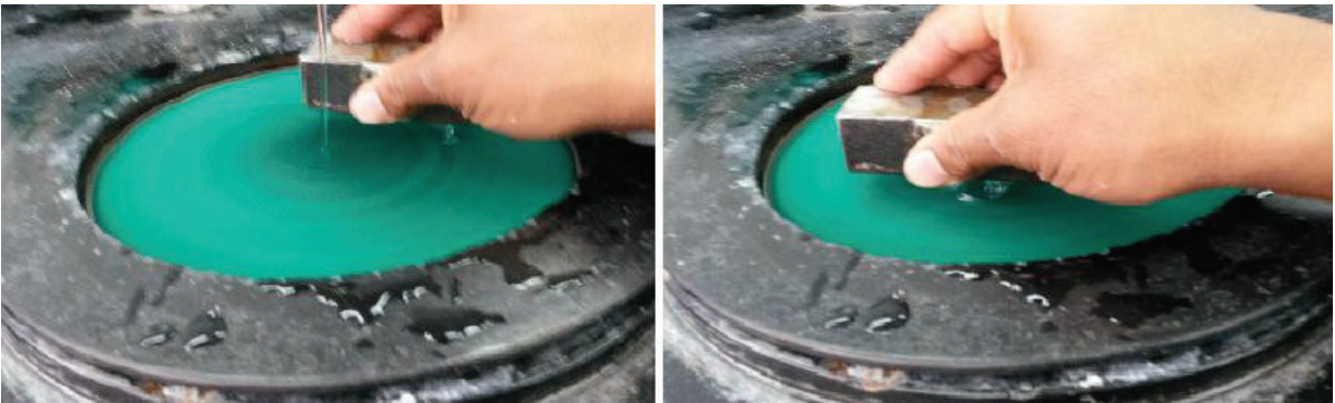
Figura 3.37.- Pulido fino con continuo chorro de agua
