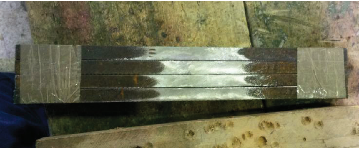
Figura 3.53.- Extracción de probetas y eliminación de sobremonta
