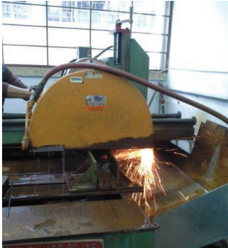
Figura 3.31.- Corte de la probeta
