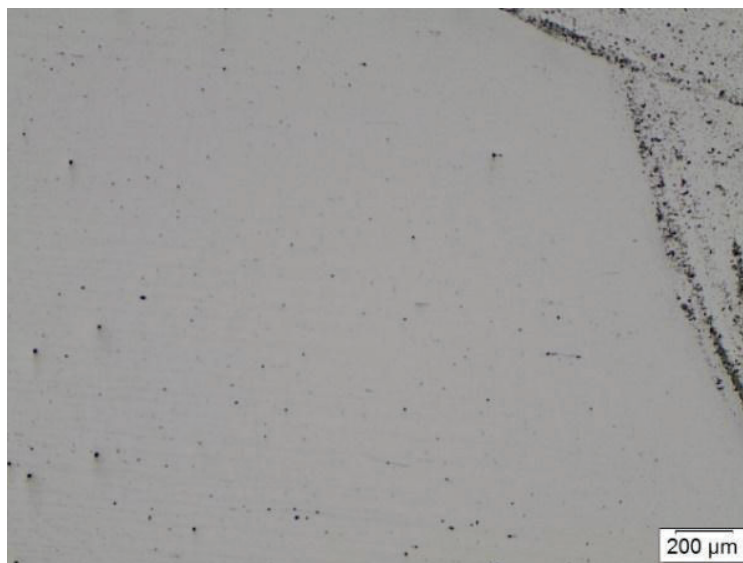
Figura 4.12.- Microestructura a 50X correspondiente al material base, ZAC y material de aporte de un acero de bajo contenido de carbono sin ataque químico
