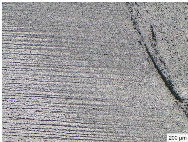
Figura 4.13.- Microestructura a 50X correspondiente al material base, ZAC y material de aporte de un acero de bajo contenido de carbono atacado químicamente con nital al 10 %
