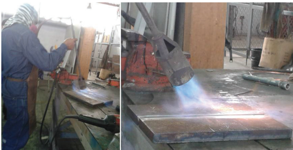
Figura 3.27.- Precalear las placas
