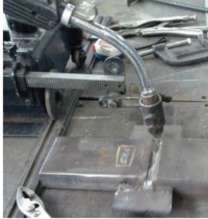
Figura 3.23.- Alineación de la probeta respecto al desplazamiento del bugo
