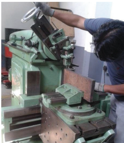
Figura 3.3.- Operador acercando la cuchilla a la placa a desbastar
