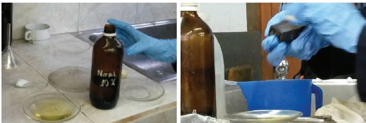
Figura 3.38.- Ataque en la superficie de la probeta
