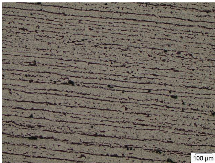
Figura 4.43.- Microestructura a 100X correspondiente al material base de un acero de bajo contenido de carbono con perlita en dirección al laminado en una matriz ferrítica.
