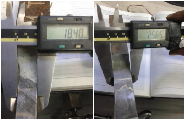
Figura 3.48.- Medición del cuello de la probeta
