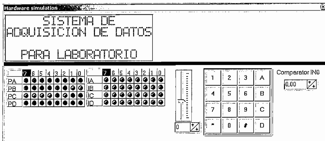
Figura 3.53 Simulador de hardware externo de Bascom-avr
