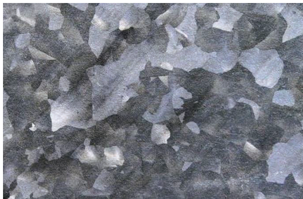
Figura 3.14 Granos de Zinc en una lámina galvanizada.
