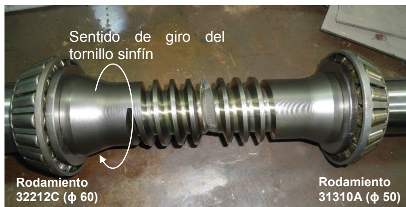
Figura 3.7 Fractura del filete en la zona de contacto con la corona, sin aumento.
