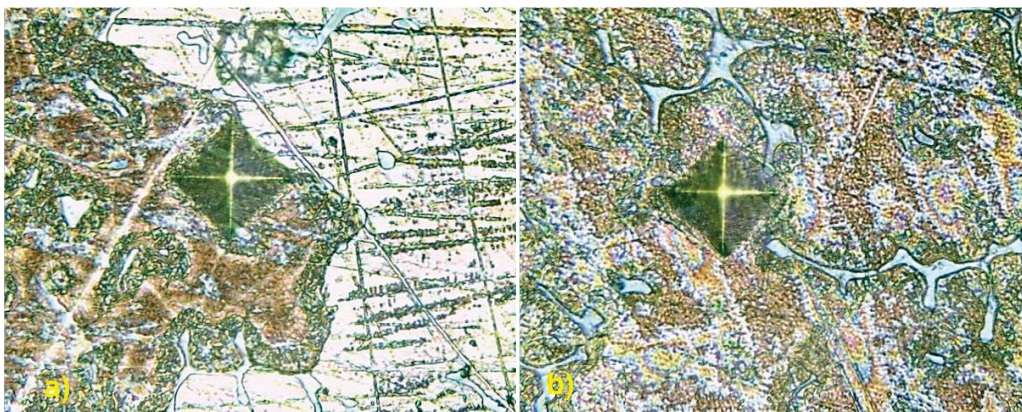
Figura 3.29 Microindentación en la corona, a) Cerca al borde exterior de la corona (punto 1), b) Zona interna de la corona (punto 5). Aumento 40X.
