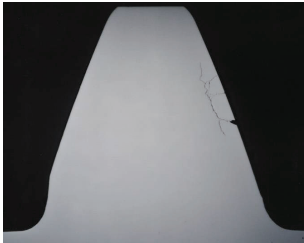
Figura 2.7 Fisura en un engranaje cementado debido a fatiga bajo la superficie endurecida
