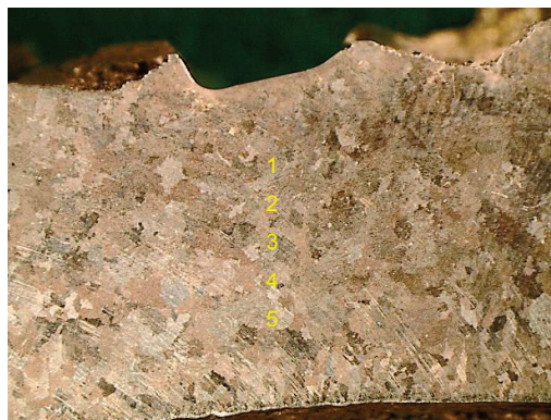
Figura 3.28 Distribución de las microindentaciones a lo largo de la dirección radial de la corona
