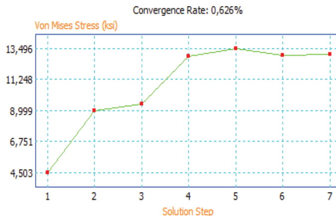
Figura 3.36 Curva de convergencia para diferentes tamaños de mallado.
