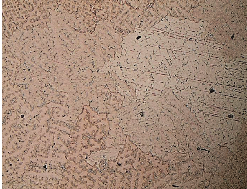
Figura 3.25 Microestructura en forma de dendritas, 100X.
