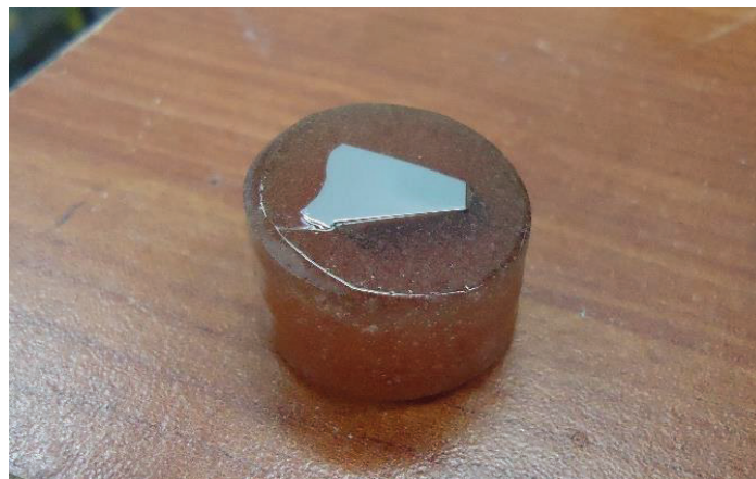
Figura 3.16 Montaje de la probeta de acero.
