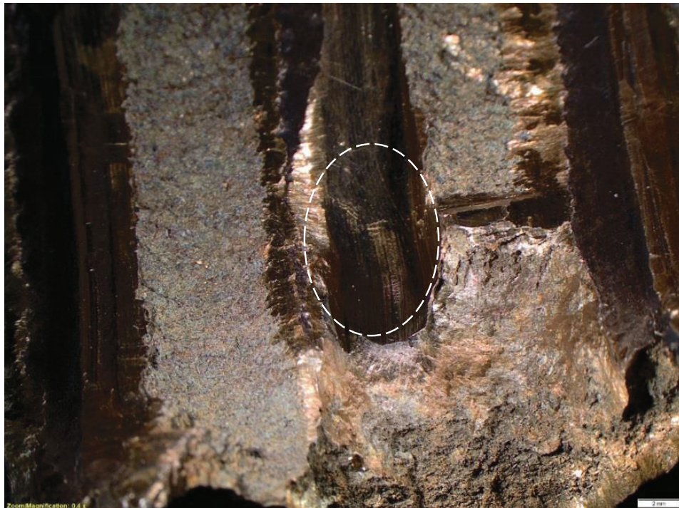
Figura 3.13 Aplastamiento en la raíz de los dientes. Aumento a 4X
