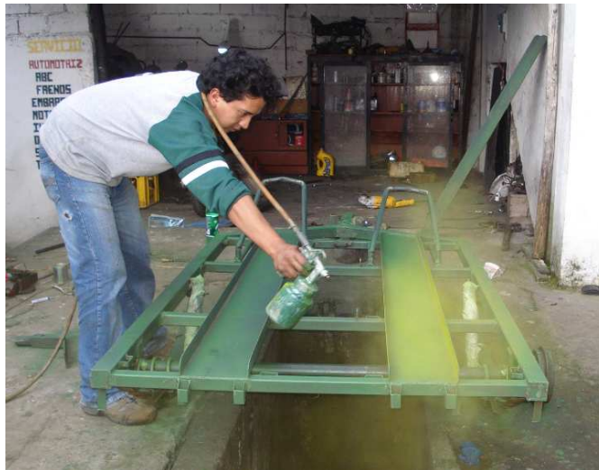
Fotografía 6.11: Aplicación de anticorrosivo.
