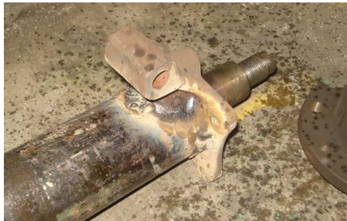
Fotografía 6.8: Soldadura de eje central con puntas de eje.
