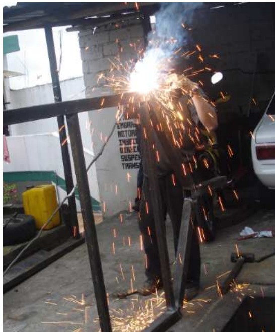
Fotografía 6.4: Montaje de sistema de tiro al bastidor.
