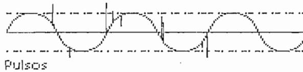
Los pulsos (impulsos, ruido proveniente de interruptores, ruido proveniente de relámpagos, etc) son incrementos de voltaje que duran desde los microsegundos a los milisegundos de ancho. La amplitud de éstos, van desde los 200 a los 6000 voltios y son producidos por relámpagos, conexión y desconexión de cargas pesadas y cortocircuitos o fallas en los sistemas de potencia.
