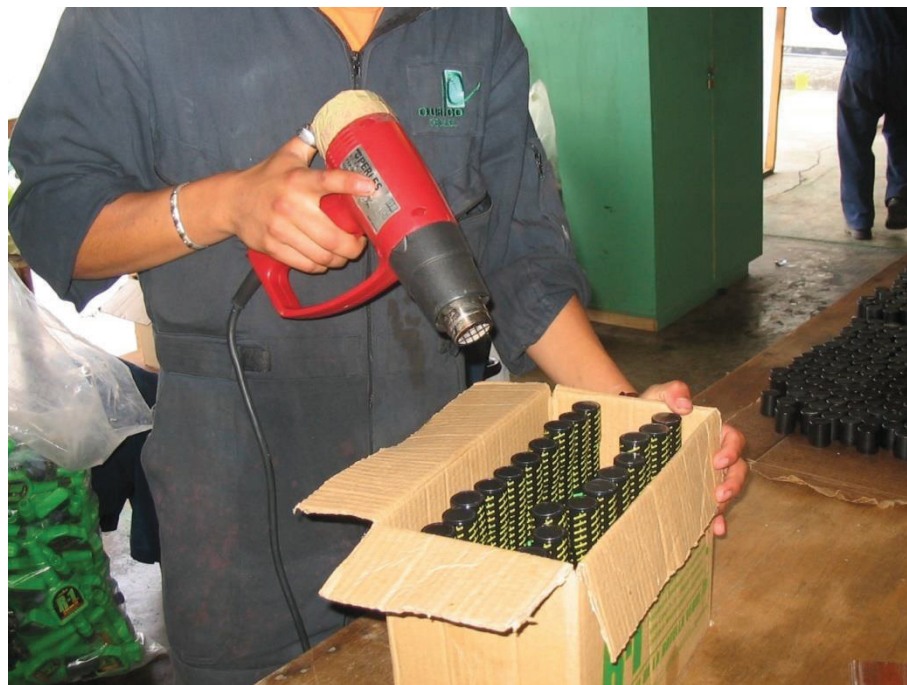
FOTOGRAFÍA 3 Colocación seguridades de botellas Qualco
