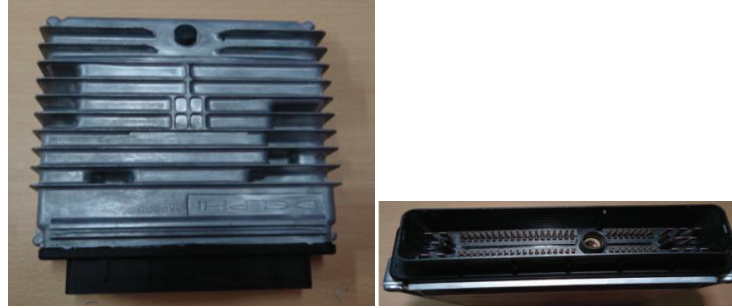
Figura 1. 17 Unidad de control electrónico del motor
