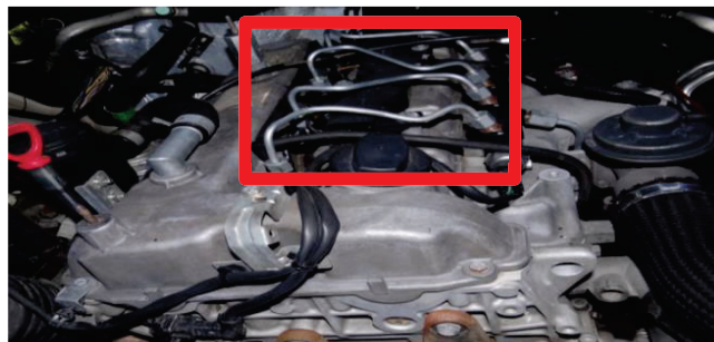
Figura 1. 13 Cañerías de alta presión de combustible
