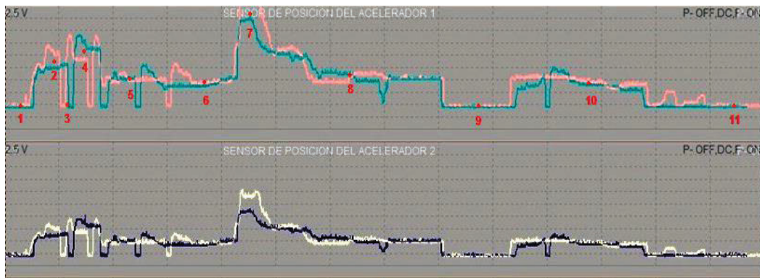
Figura 4. 26 Forma de onda APS en el ciclo de prueba Prueba dinámica del APS 1 y APS 2 respecto al tiempo de prueba Rojo y Amarillo: Medición a 2300 msnm Verde y Azul: Medición a 0 msnm
