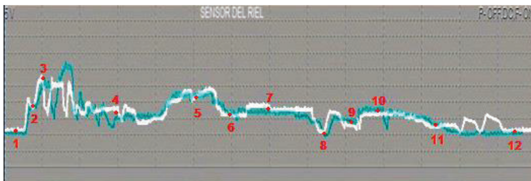
Figura 4. 27 Forma de onda del sensor de presión del riel en el ciclo de prueba Blanco: Medición en la altura Turquesa: Medición a nivel del mar
