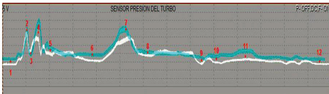
Figura 4. 28 Forma de onda del sensor de presión del turbo en el ciclo de prueba
