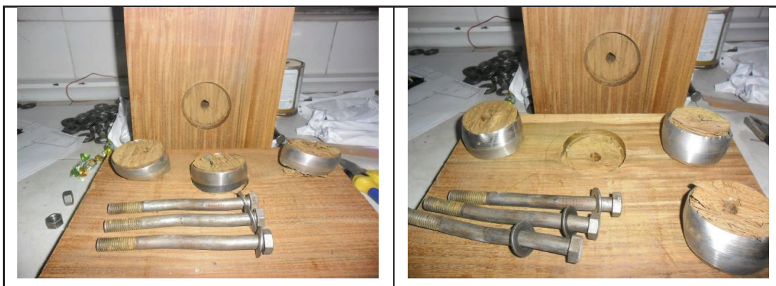
FIGURA 3.39 MODO DE FALLA GUAYCÁN APPEL CORTE SIMPLE
