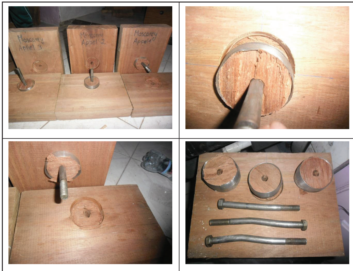
FIGURA 3.37 MODO DE FALLA MASCAREY APPEL CORTE SIMPLE
