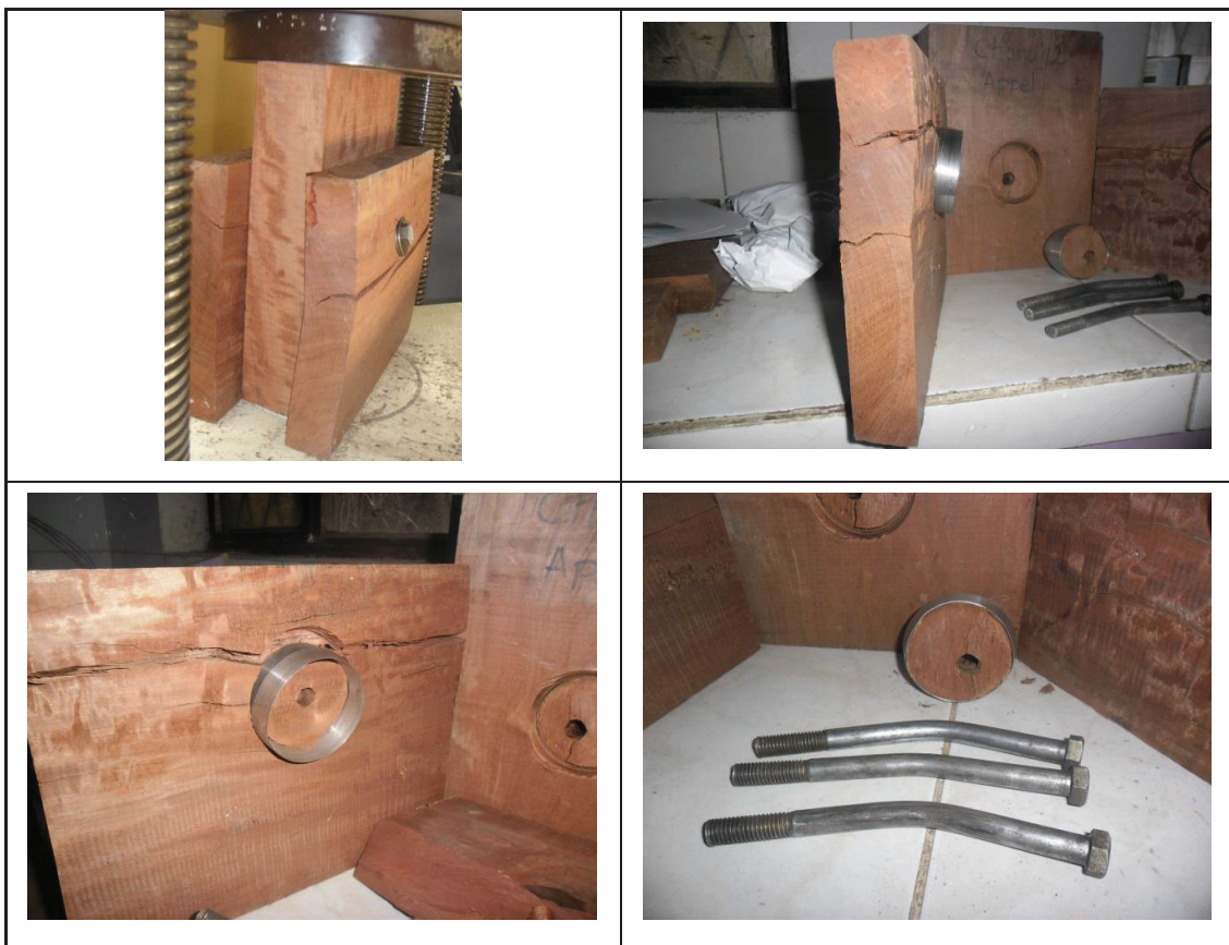
FIGURA 3.42 MODO DE FALLA PROBETAS CHANUL CORTE DOBLE
