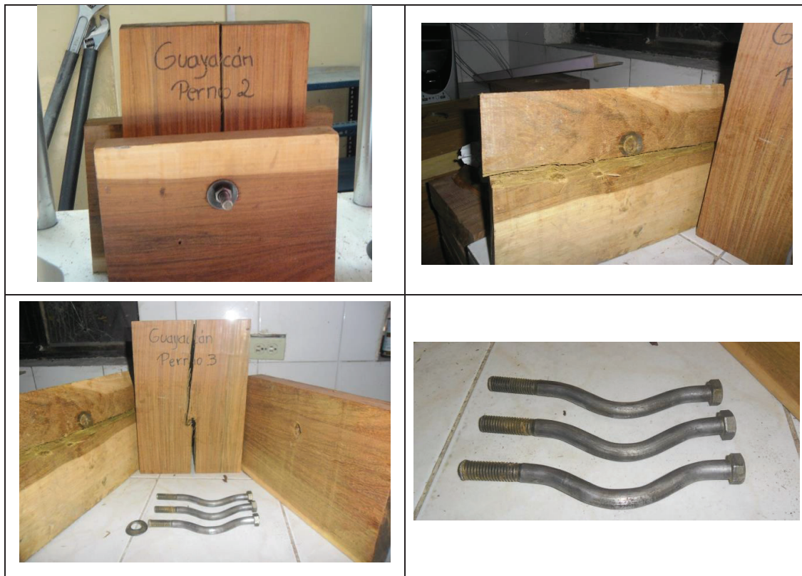
FIGURA 3.13 MODO DE FALLA PROBETAS GUAYACÁN CORTE DOBLE
