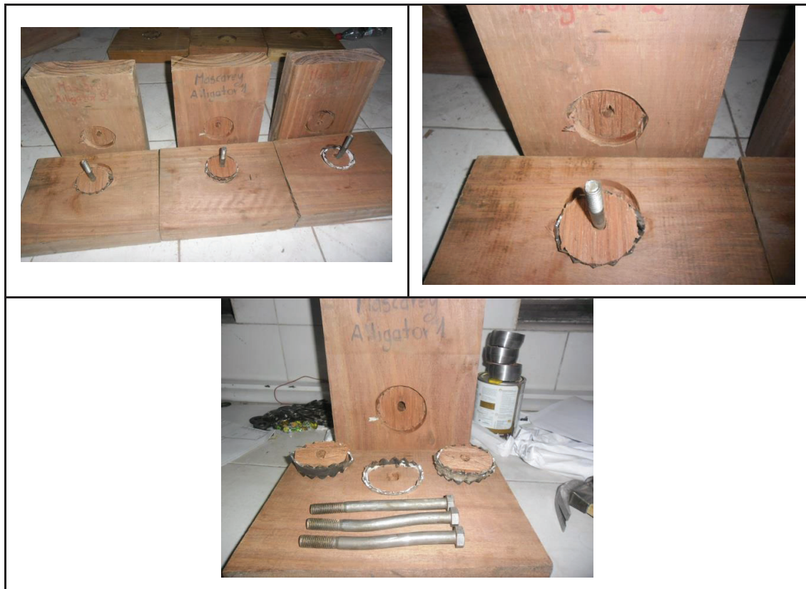
FIGURA 3.52 MODO DE FALLA MASCAREY ALLIGATOR CORTE SIMPLE
