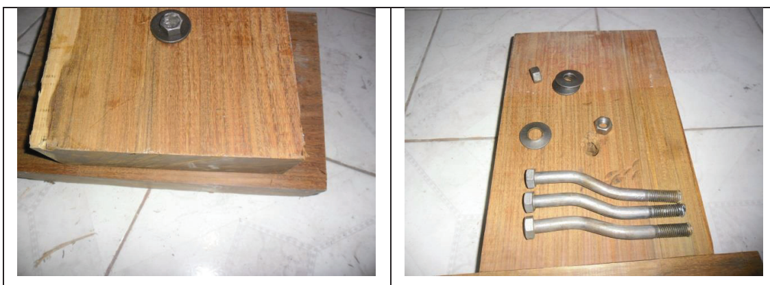
FIGURA 3.9 MODO DE FALLA PROBETAS GUAYACÁN CORTE SIMPLE
