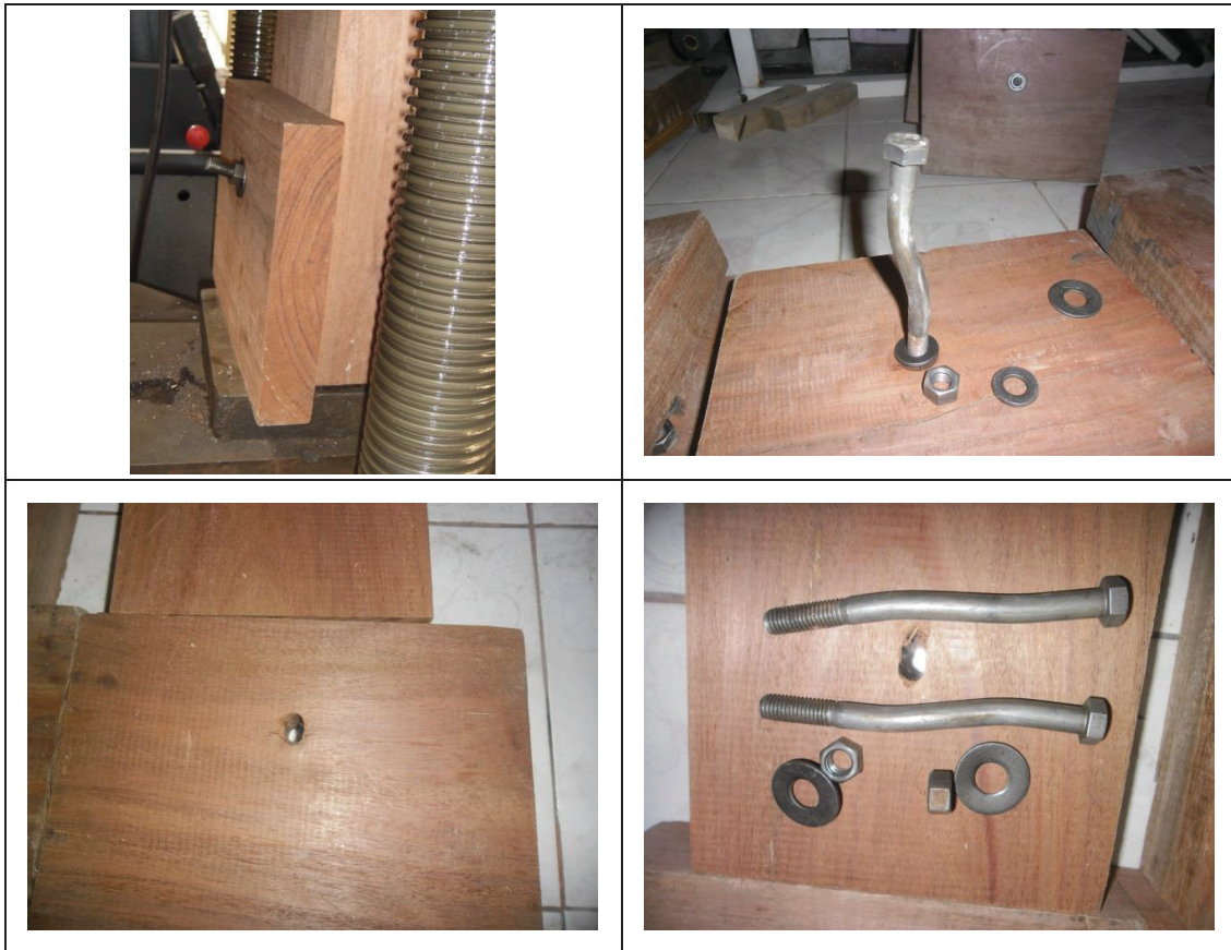
FIGURA 3.7 MODO DE FALLA PROBETAS MASCAREY CORTE SIMPLE
