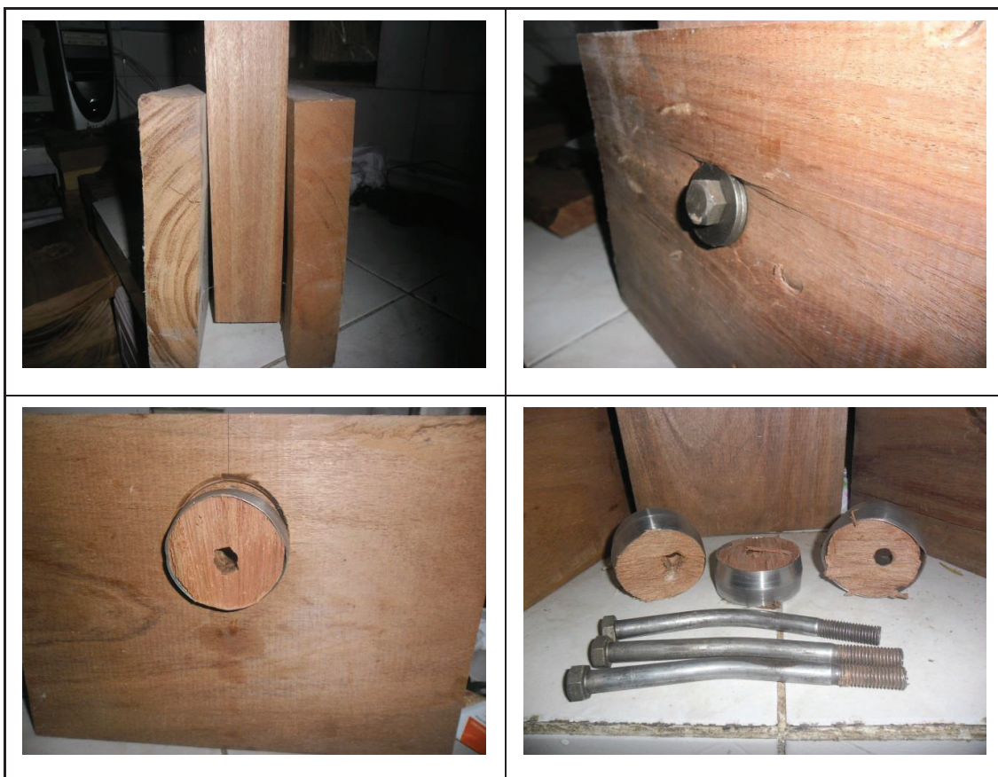
FIGURA 3.41 MODO DE FALLA PROBETAS MASCAREY CORTE DOBLE
