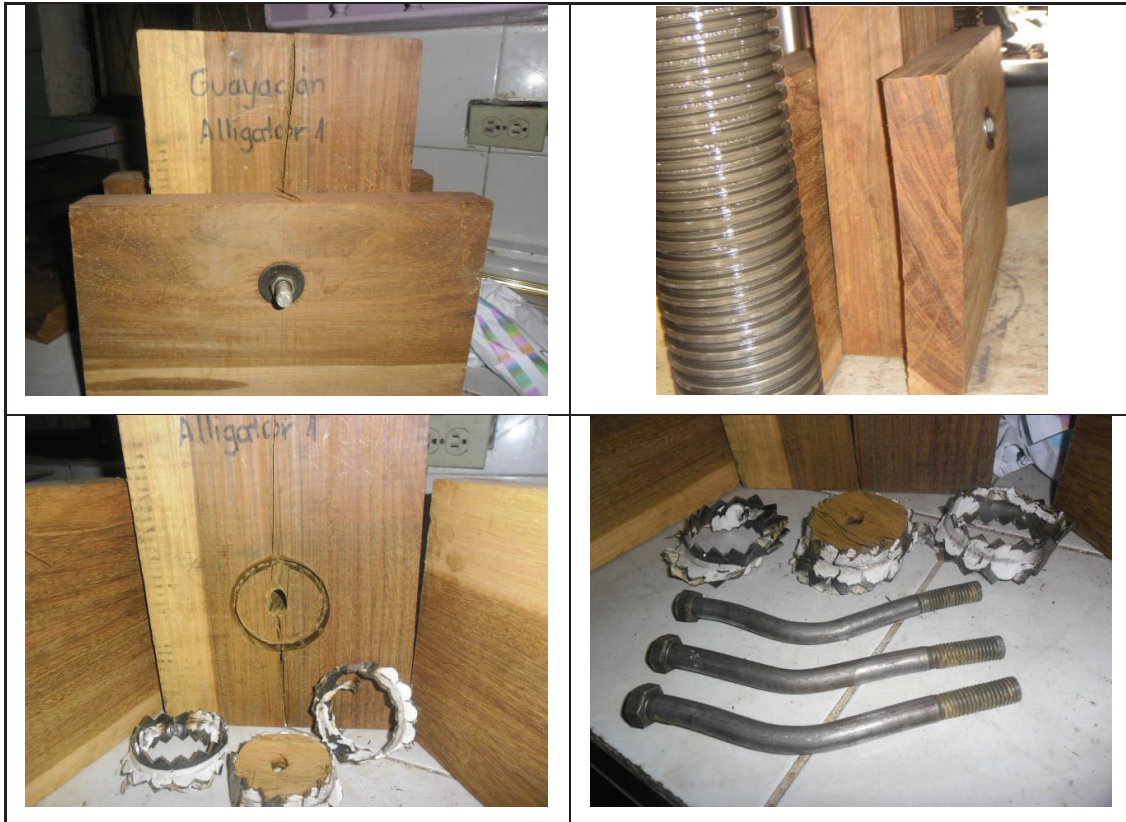
FIGURA 3.58 MODO DE FALLA PROBETAS GUAYACÁN CORTE DOBLE
