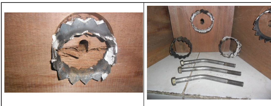
FIGURA 3.56 MODO DE FALLA PROBETAS MASCAREY CORTE DOBLE
