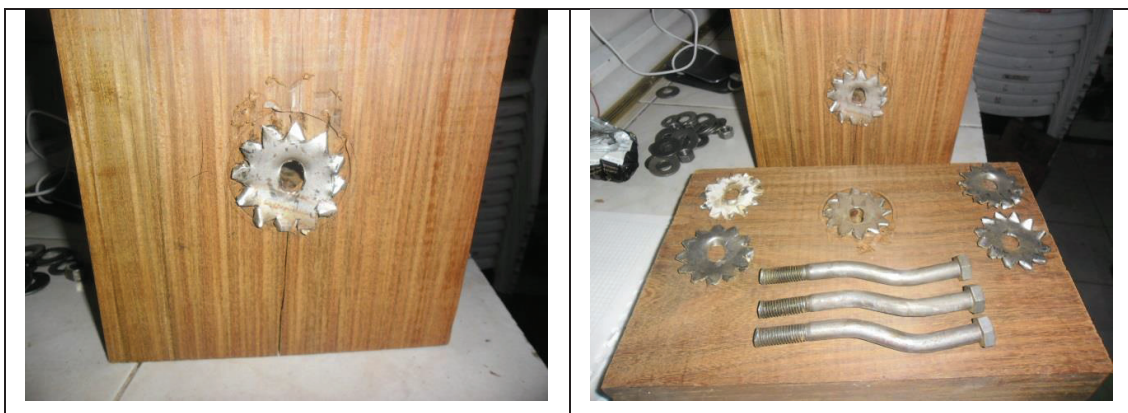
FIGURA 3.24 MODO DE FALLA GUAYACÁN BULLDOG CORTE SIMPLE
