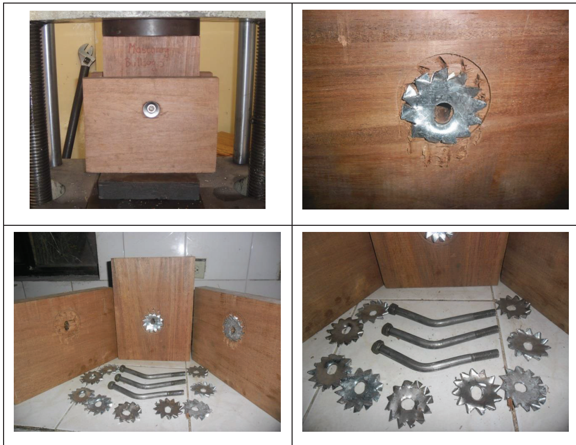
FIGURA 3.26 MODO DE FALLA PROBETAS MASCAREY CORTE DOBLE
