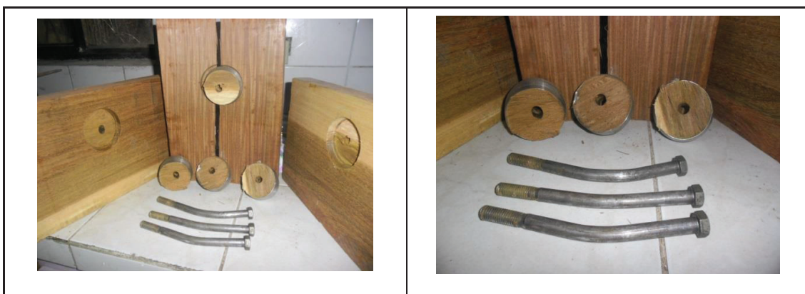
FIGURA 3.43 MODO DE FALLA PROBETAS GUAYACÁN CORTE DOBLE
