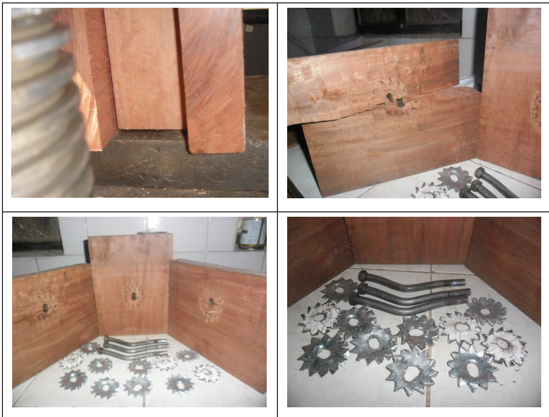
FIGURA 3.27 MODO DE FALLA PROBETAS CHANUL CORTE DOBLE
