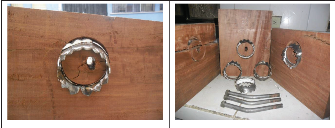
FIGURA 3.57 MODO DE FALLA PROBETAS CHANUL CORTE DOBLE
