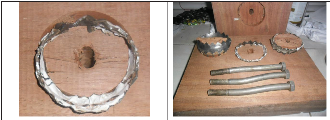
FIGURA 3.53 MODO DE FALLA CHANUL ALLIGATOR CORTE SIMPLE
