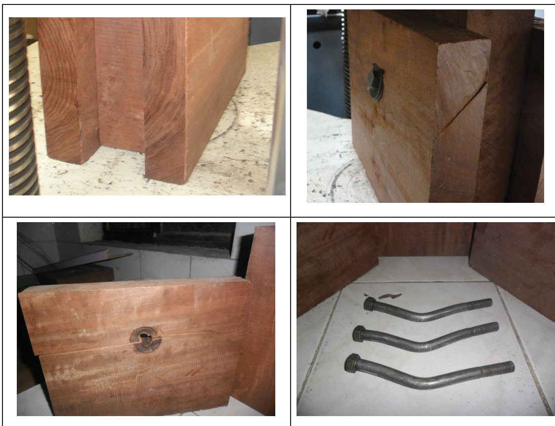
FIGURA 3.12 MODO DE FALLA PROBETAS CHANUL CORTE DOBLE
