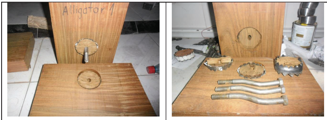
FIGURA 3.54 MODO DE FALLA GUAYCÁN ALLIGATOR CORTE SIMPLE
