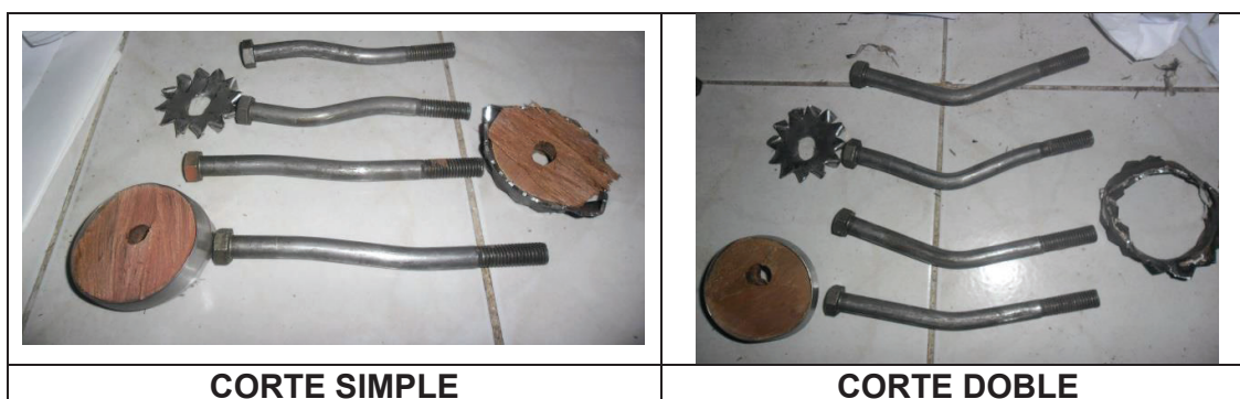
FIGURA 4.2 DEFORMACIÓN DE CONECTORES EN CHANUL
