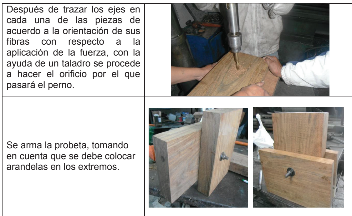
FIGURA 3.4 ENSAMBLE DE PROBETAS EMPERNADAS
