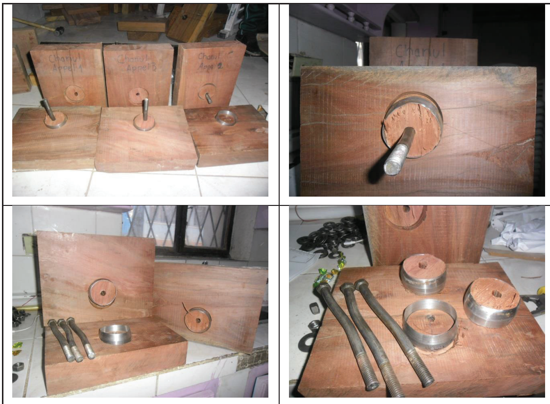
FIGURA 3.38 MODO DE FALLA CHANUL APPEL CORTE SIMPLE
