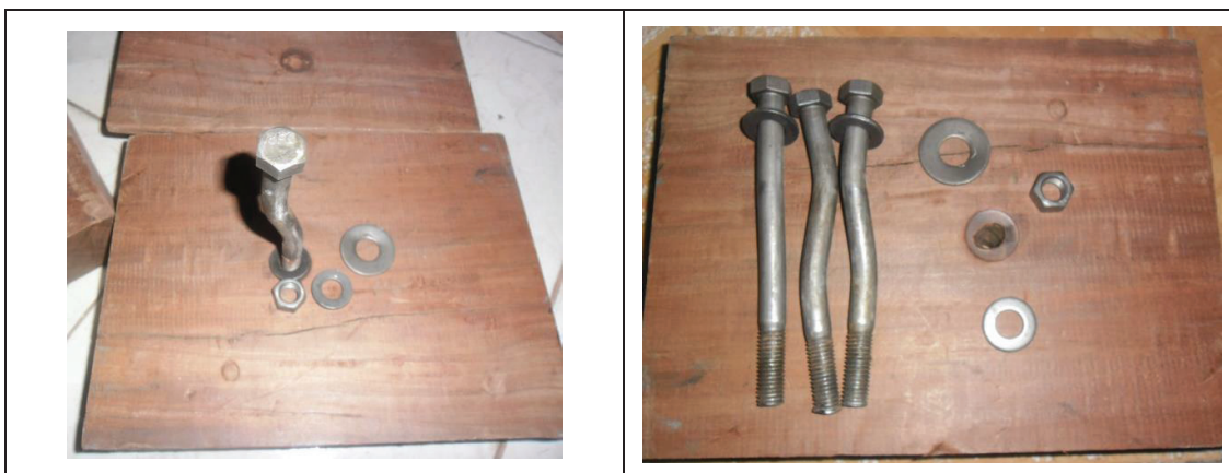
FIGURA 3.8 MODO DE FALLA PROBETAS CHANUL CORTE SIMPLE
