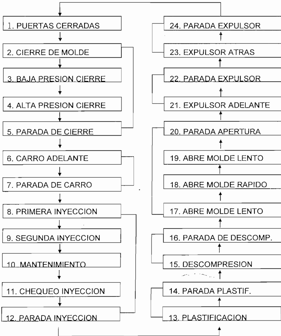
Fig. 2.5 Ciclo de inyección
