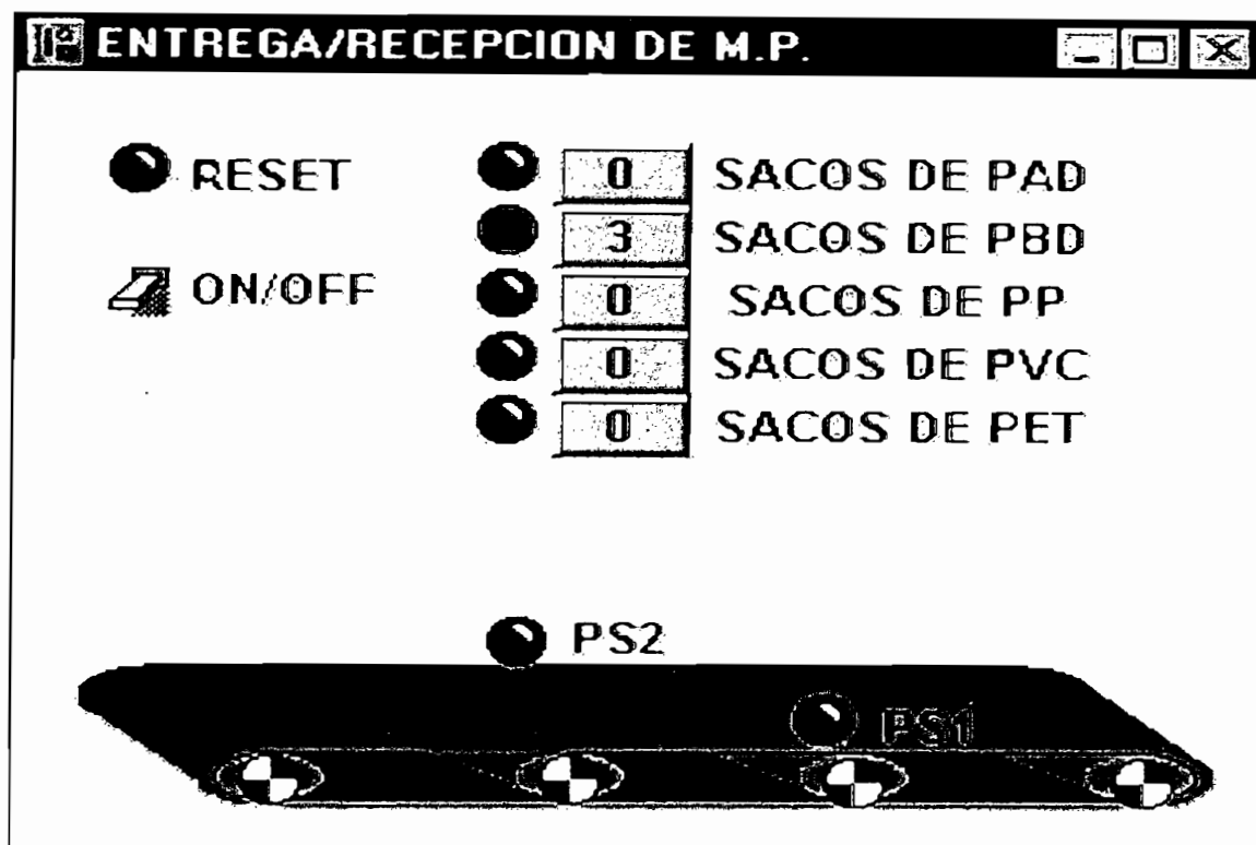
Fig. 4.1 Panel de control para conteo de sacos de materia prima
