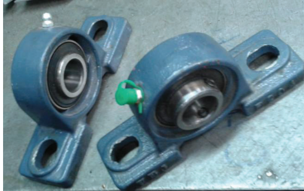
Figura 4.47. Acoplamiento de las chumaceras.
