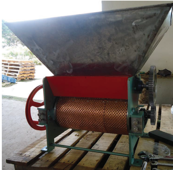
Figura 4.48. Ensamble de la tolva.
