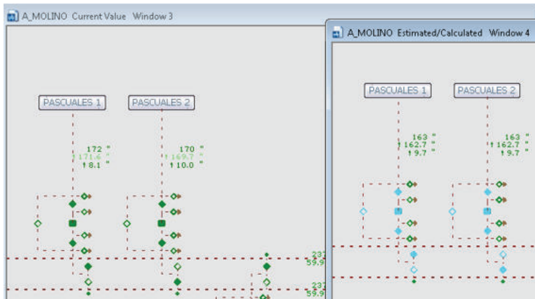
Figura 4.20: Valores Medidos y Estimados de L/T PASC MOLI 1 en S/E Molino en sistema EMS
