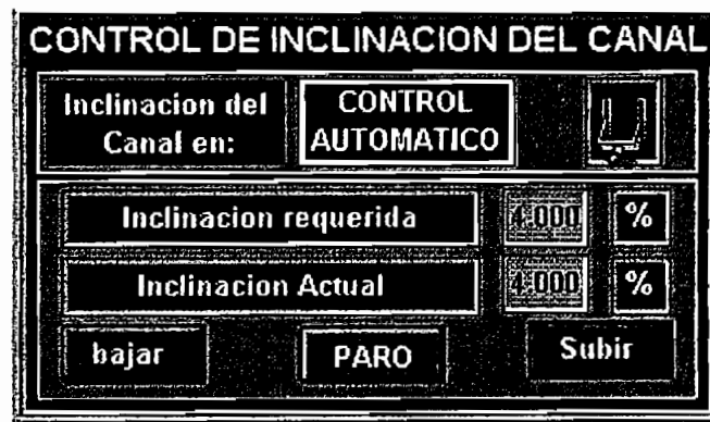
Fig. 4.10 Control Automático de la Inclinación del Canal
